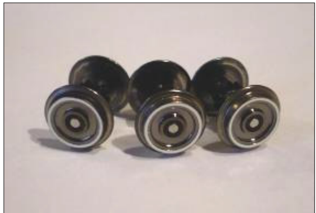
Obr.19 - Detail vyjmutých dvojkolí
