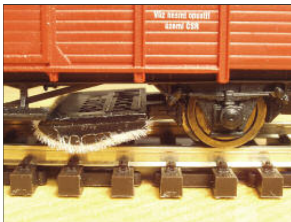
Obr.4 – Kartáček leží vlastní vahou bez přítlaku
