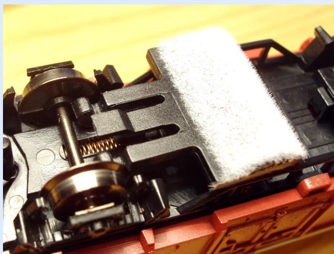
Obr. 6: Na vozech s kinematikou Tillig nelze kartáčky použít.
