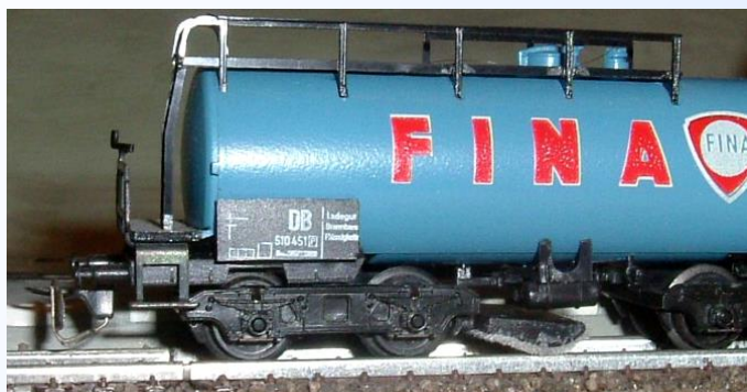
Obr. 15 a 16: Kartáček na 4nápravovém kotlovém voze BTTB.
