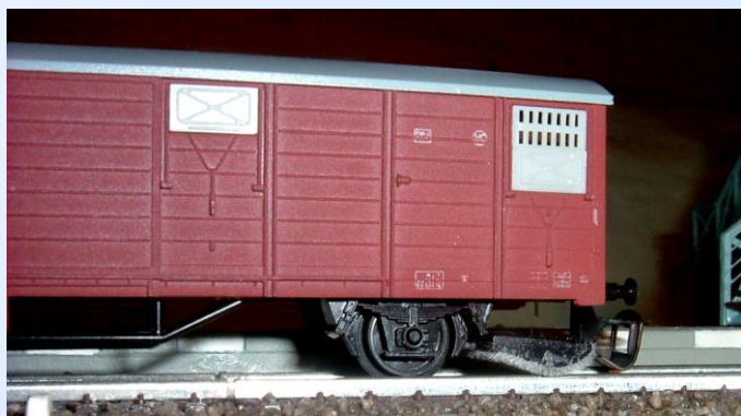
Obr. 19: Někdy lze kartáček instalovat i z vnější strany.
