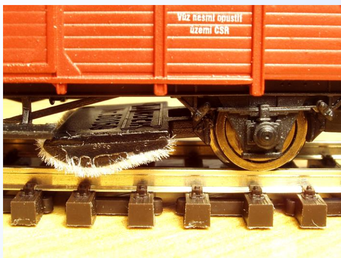
Obr. 3: Kartáček leží vlastní vahou bez přitlaku.
