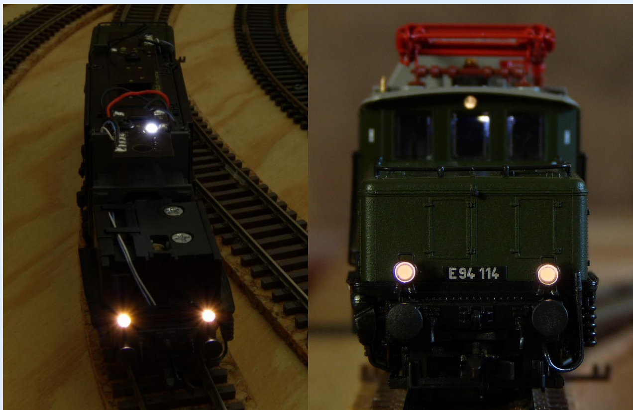
Obr. 18 a 19: Osvětlení modelu. Ledka pro horní reflektor má studeně bílý odstín, ovšem přes nabarvený světlovod získává teplejší barvu než poziční světla. Intenzita jejího svitu je však díky tomu nižší. Na snímku vpravo je okna viditelná i průnik světla do stanoviště strojvedoucího.
