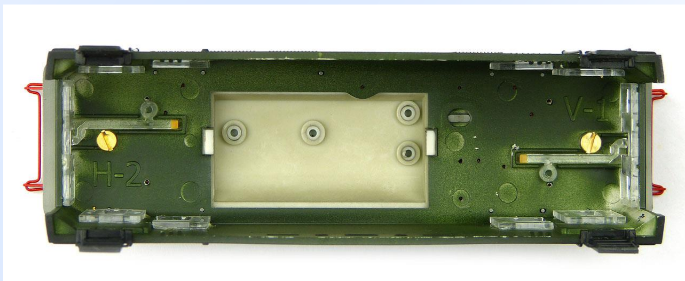
Obr. 14: Pohled do vnitřku skříňe. Patrné jsou zámky střešní nástavby, šroubky pro uchycení pantografů i žlutě zabarvené vstupní plošky světlovodů pro vrchní reflektory.
