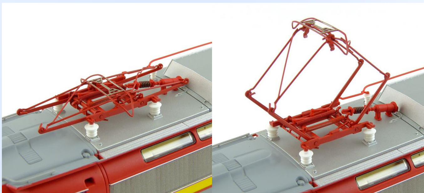
Obr. 15: a 16: Složený a zdvižený pantograf.
