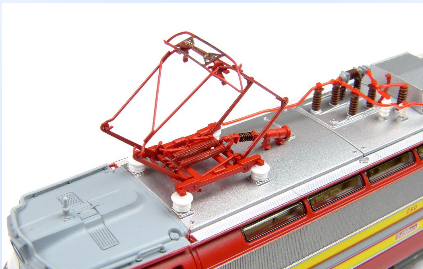
Obr. 14 a 15: Složený a zdvižený pantograf.
