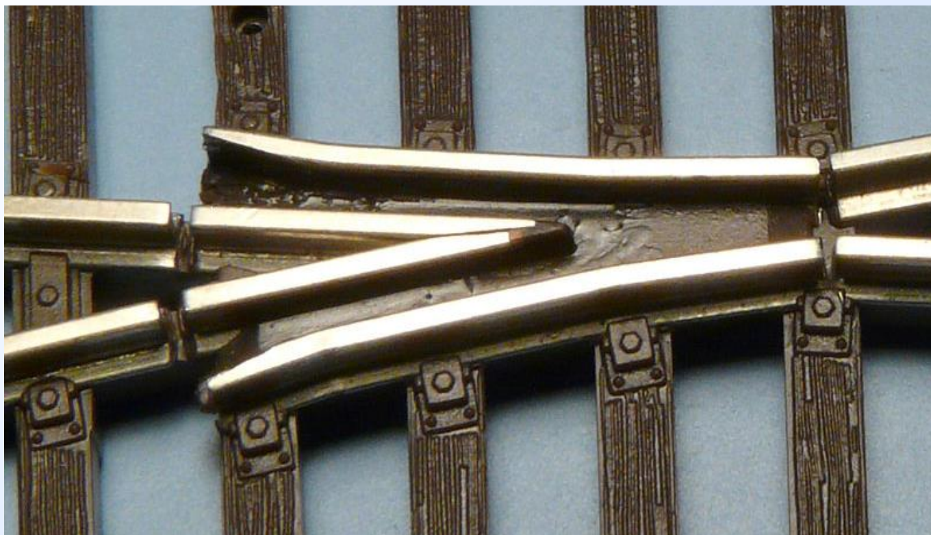
Obr. 3: Kovová, elektricky oddělená srdcovka s možností napájení.
