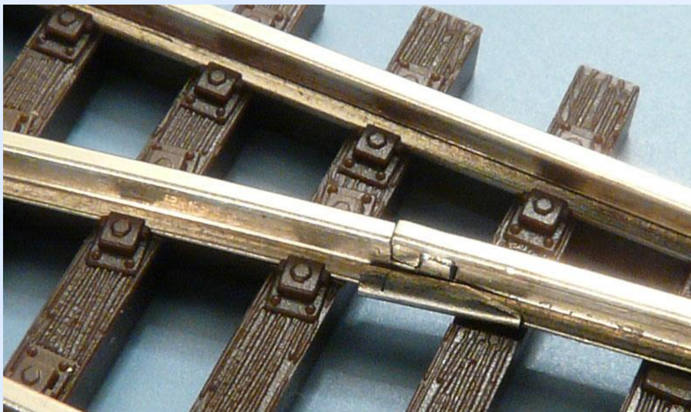
Obr. 2: Spojka pevné a pohyblivé části jazyka.
