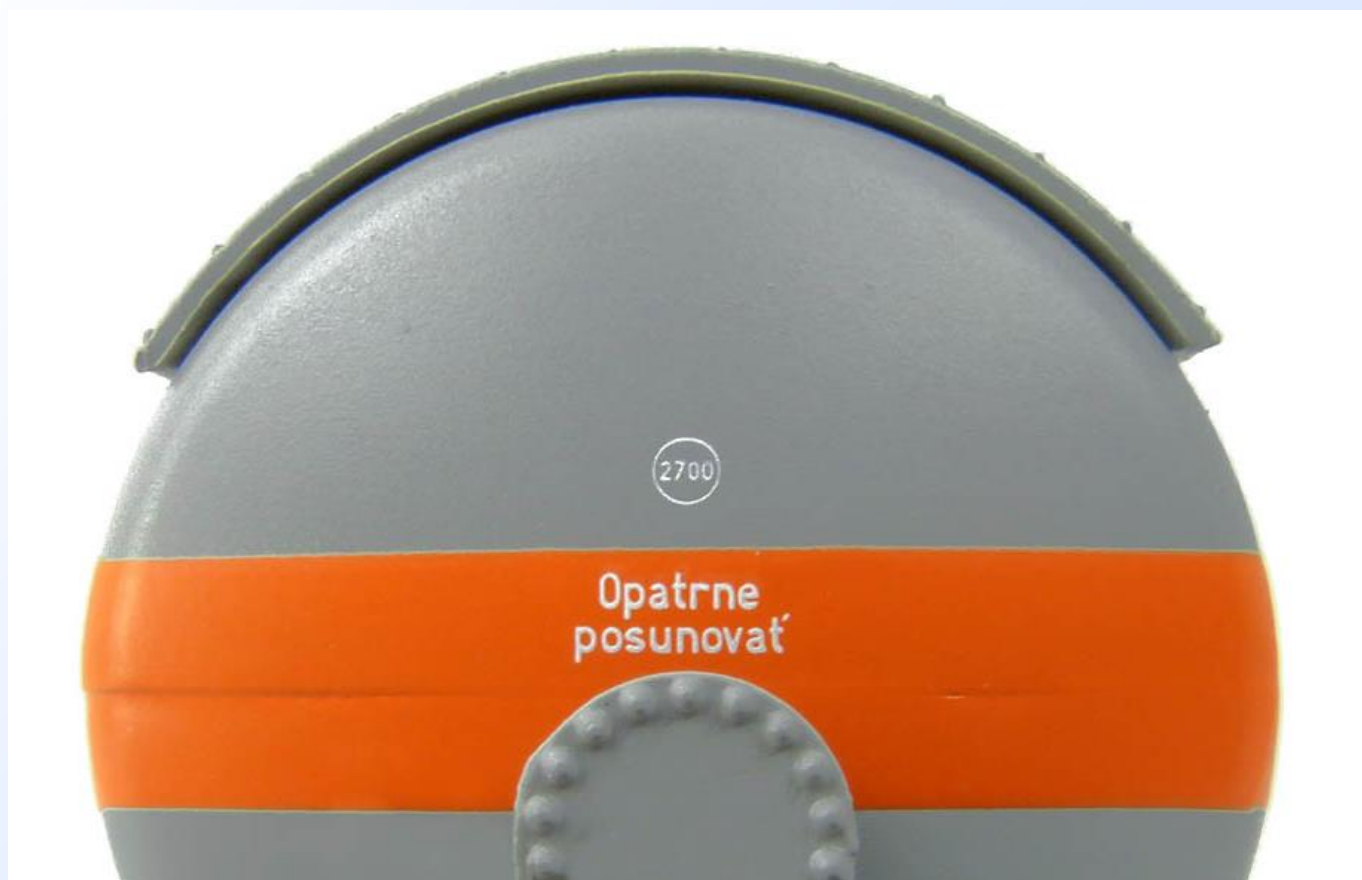
Obr. 10: Nedokonalosti spoje v oranžovém pruhu na kotli.
