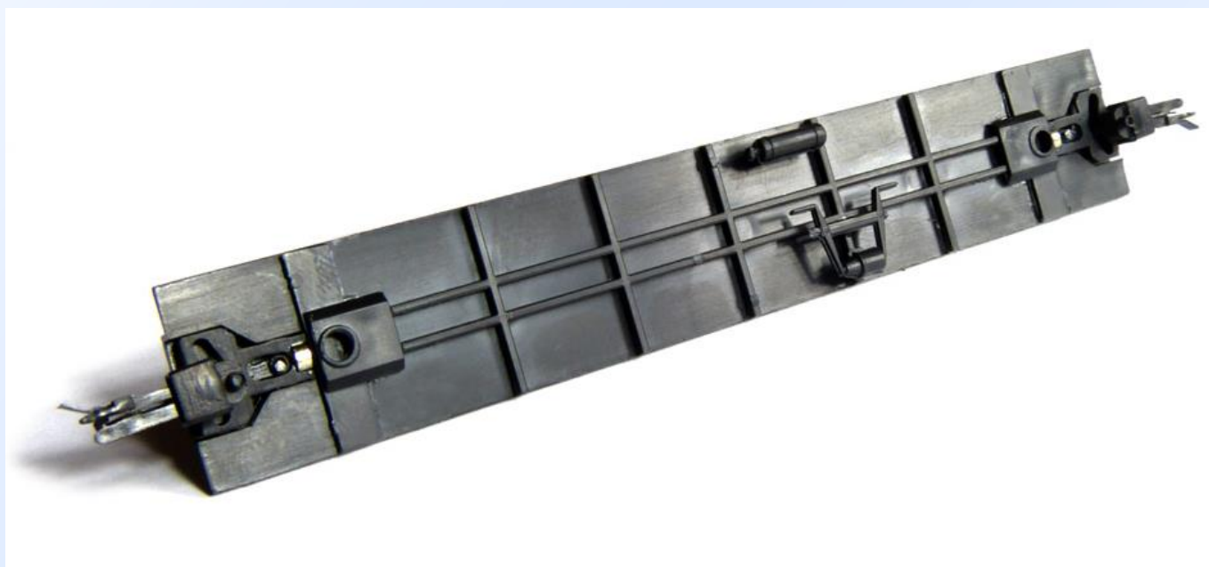
Obr. 5: Spodek vozu s osazenými doplňky a kinematikami.
