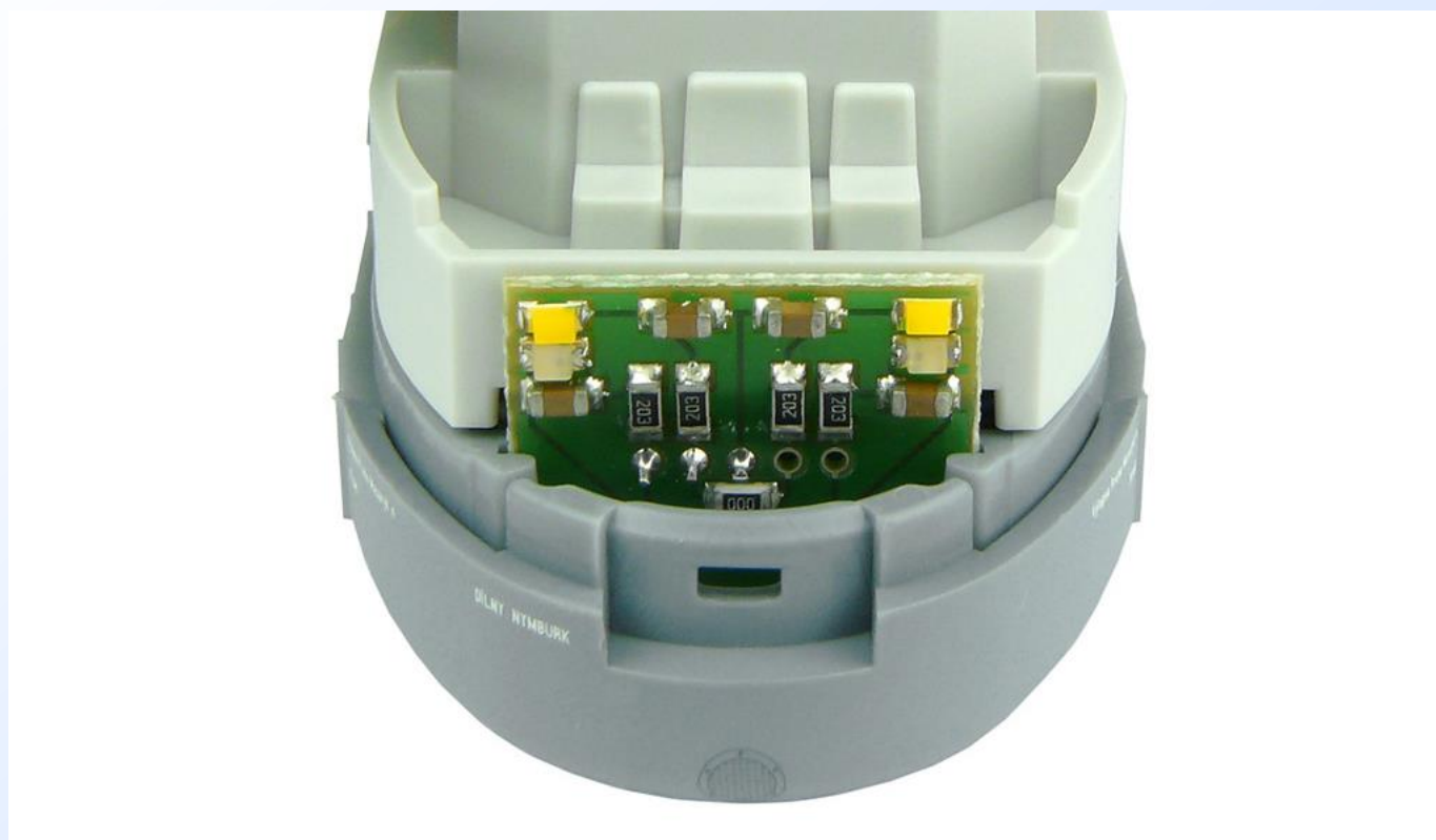
Obr. 13: Odkryté čelo s DPS.
