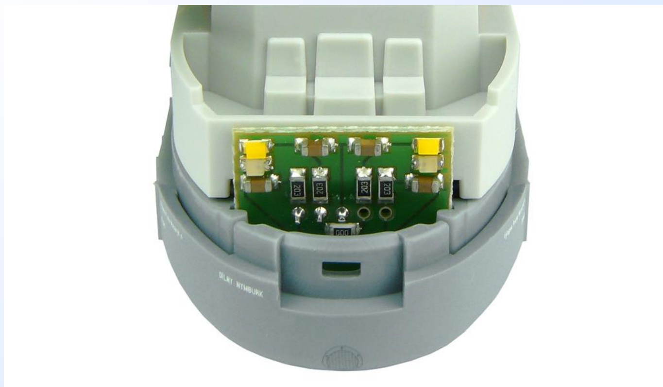
Obr. 13: Odkryté čelo s DPS.
