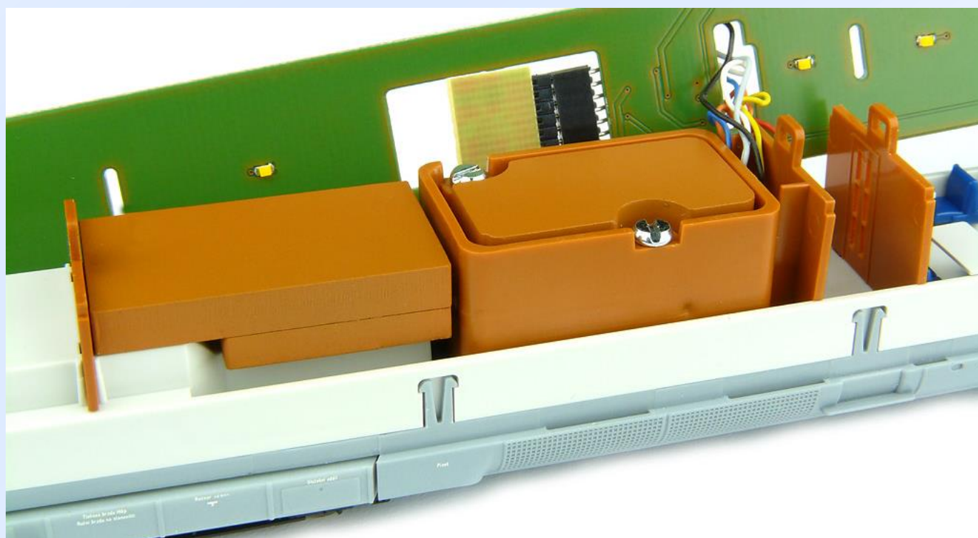
Obr. 10: Závaží a kryt motorou..
