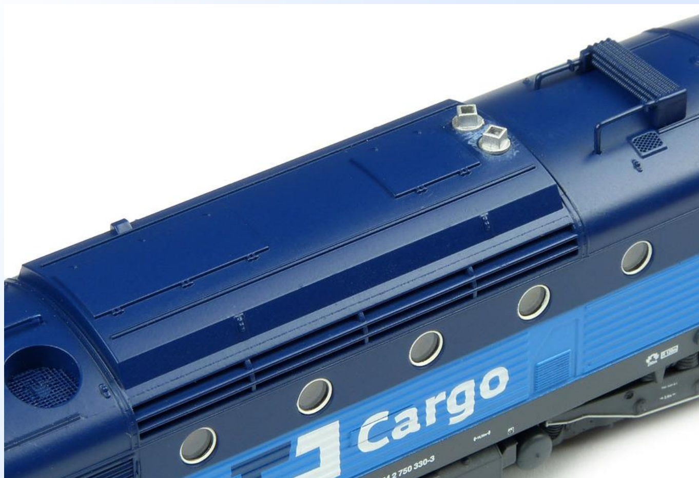
Obr. 7: Detail střešních partií s přepracovanými žaluziemi a „mapami“, zřejmě od lepidla.
