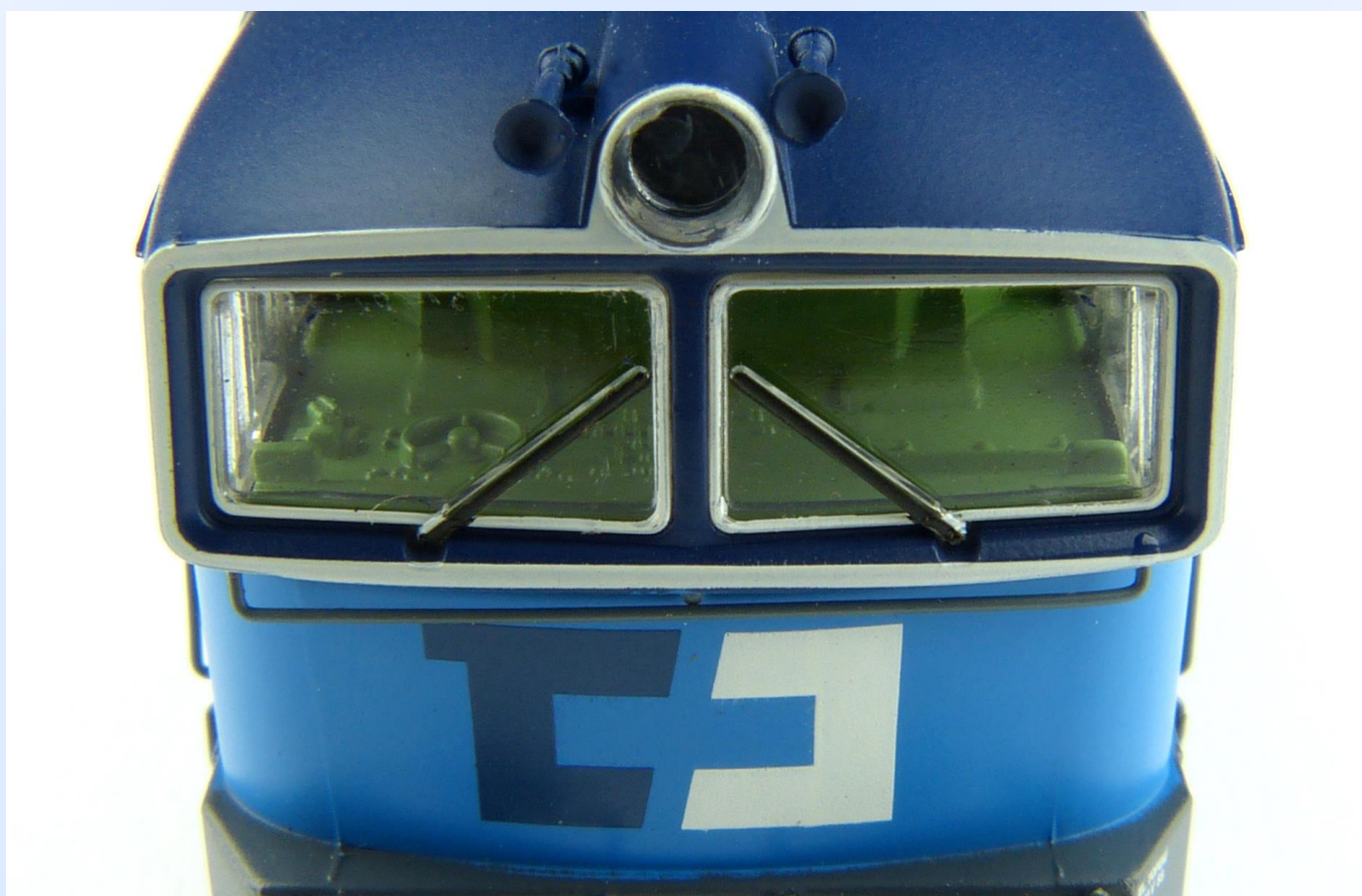
Obr. 6: Pohled na čelo a do kabiny. Pozornosti neujdou otřepy na čele ve spodní části fotografie.
