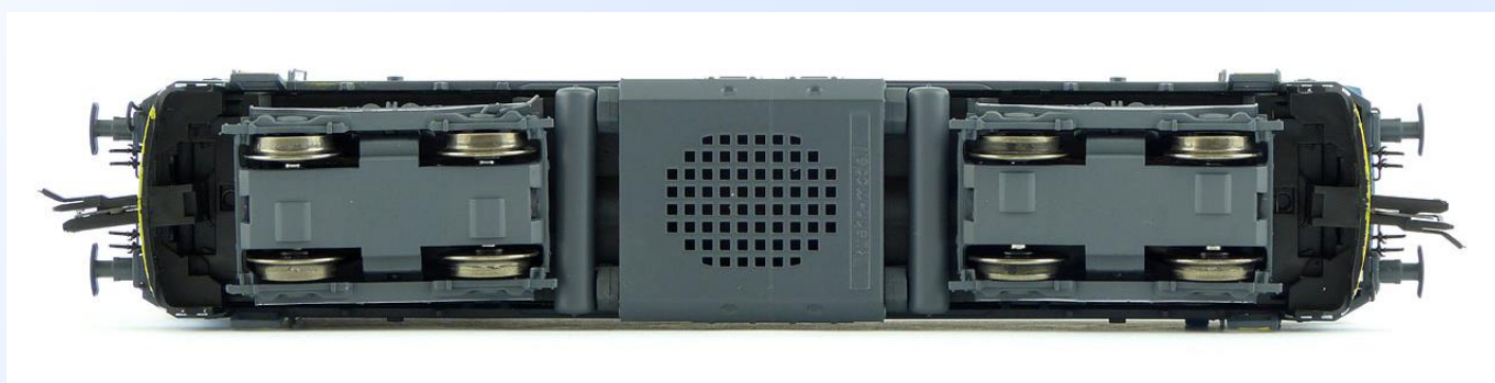
Obr. 5: Spodní pohled na model. V nádrži jsou otvory pro lepší průchod zvuku z reproduktoru.
