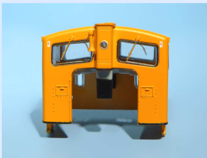
Obr. 11: Budka strojvedoucího - čelní pohled.
