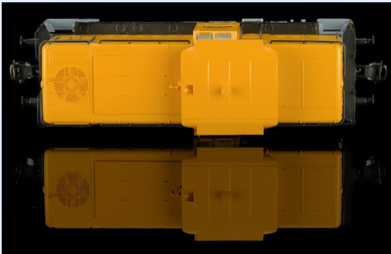
Obr. 3: Pohled na vrchní partii. Patrné jsou i lopatky ventilátoru v delší kapotě.
