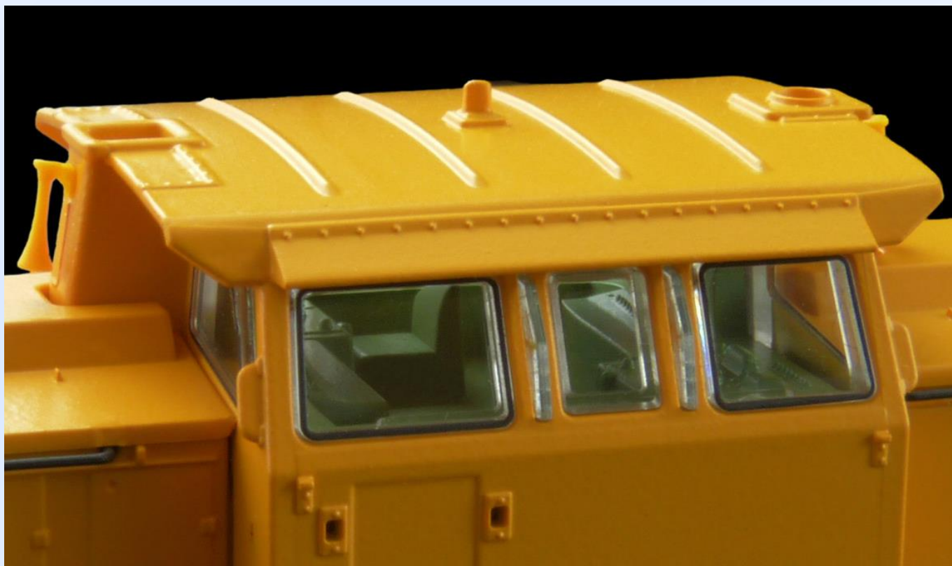
Obr. 8: Pohled do kabiny, kde je patrné stanoviště strojvedoucího.
