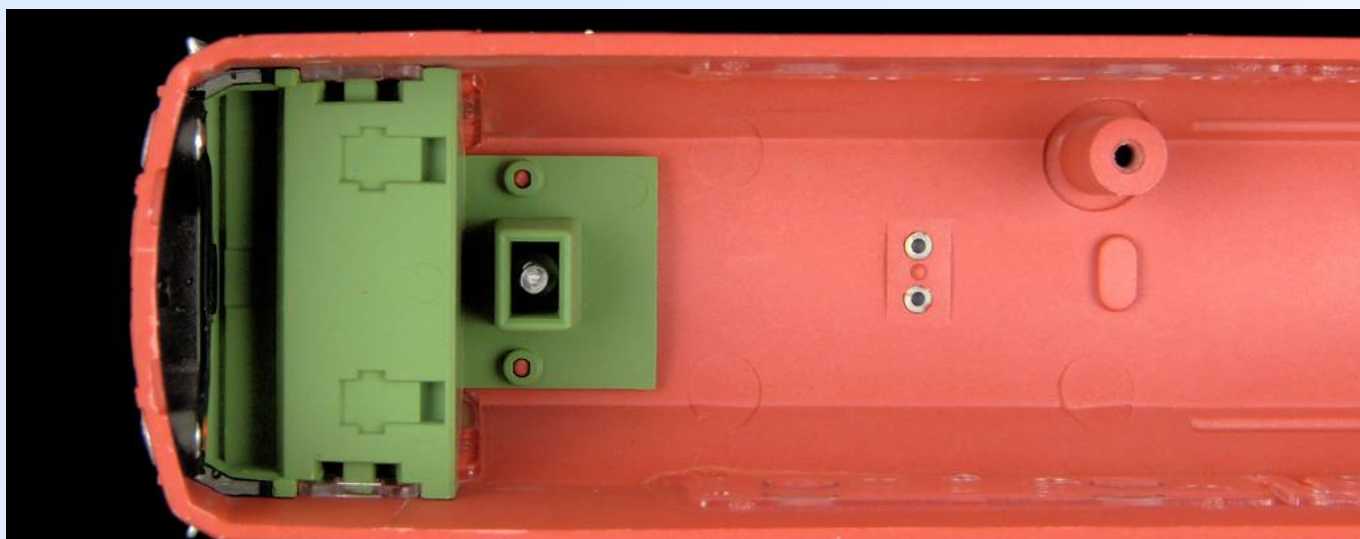
Obr. 21: Pohled zevnitř na spodek stanoviště a světlovod pro nadokenní reflektor.
