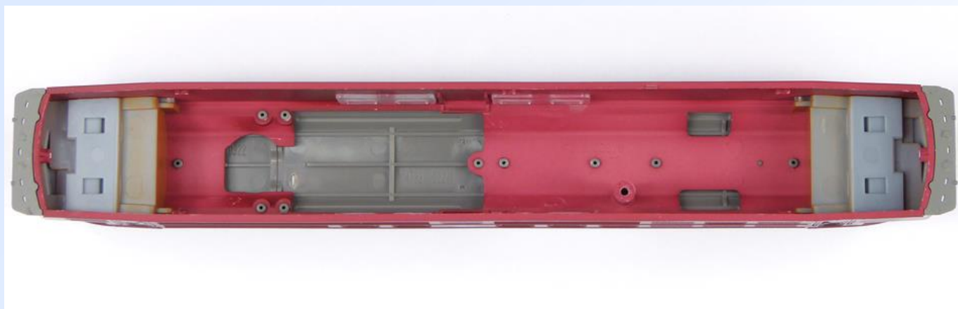
Obr. 23: Celkový pohled na vnitřek skříně. V dolní části je vidět závit pro uchycení skříně na rám. Malé čepy drží jednotlivé díly střechy.
