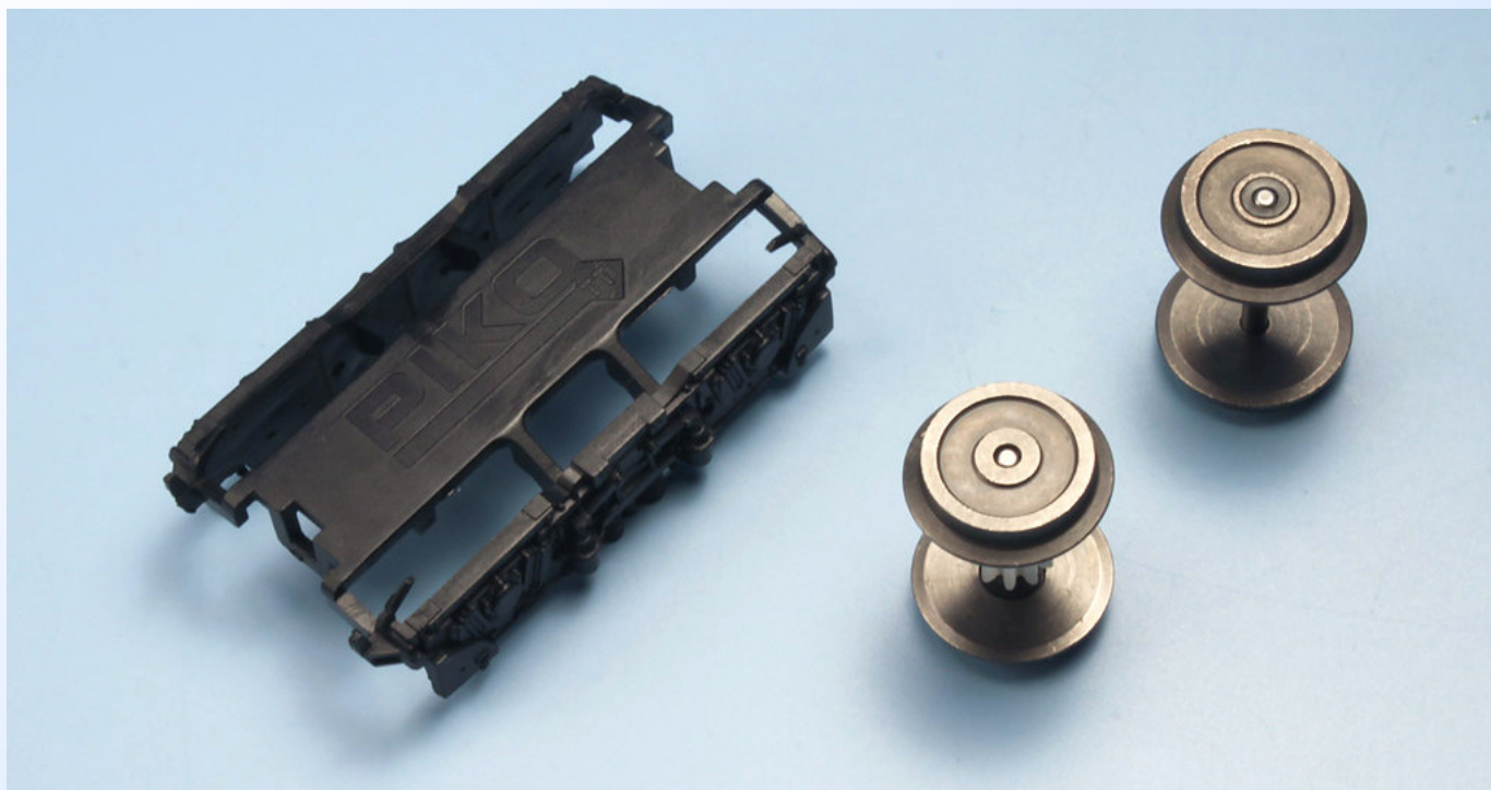
Obr.6: Kryt podvozku a celokovová dvojkolí. Na horním je patrná izolační vložka.
