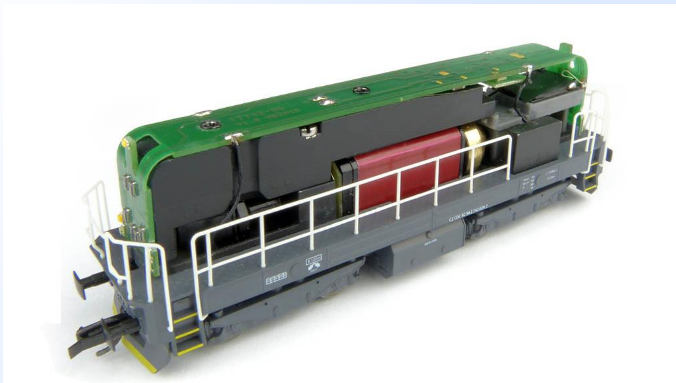
Obr. 15: Vnitřní uspořádání modelu.
