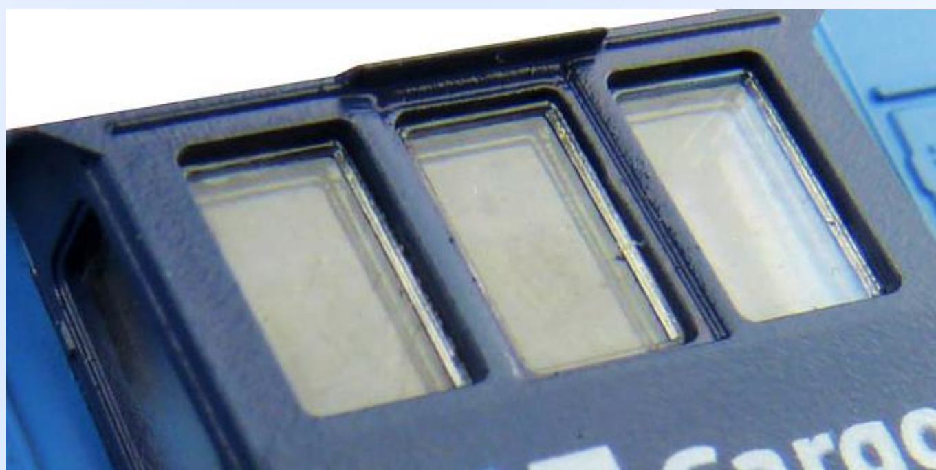
Obr. 6: Skla v oknech jsou zapuštěná a postrádají těsnění. Rádus v jejich rozích neodpovídá skutečnosti.
