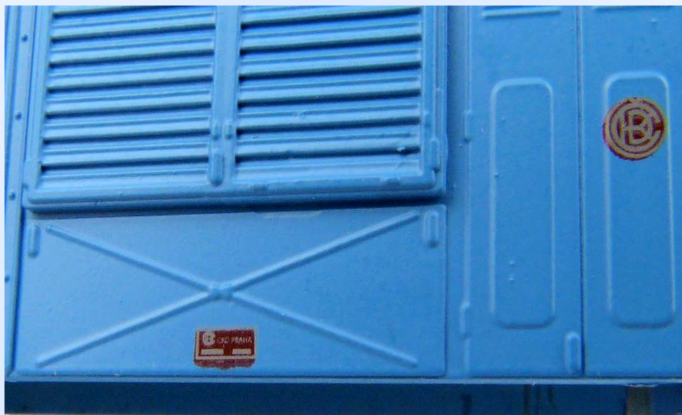
Obr. 12: Opět špatný soutisk a nepovedené napodobení jehlanovitých prolisů na boku skříně.
