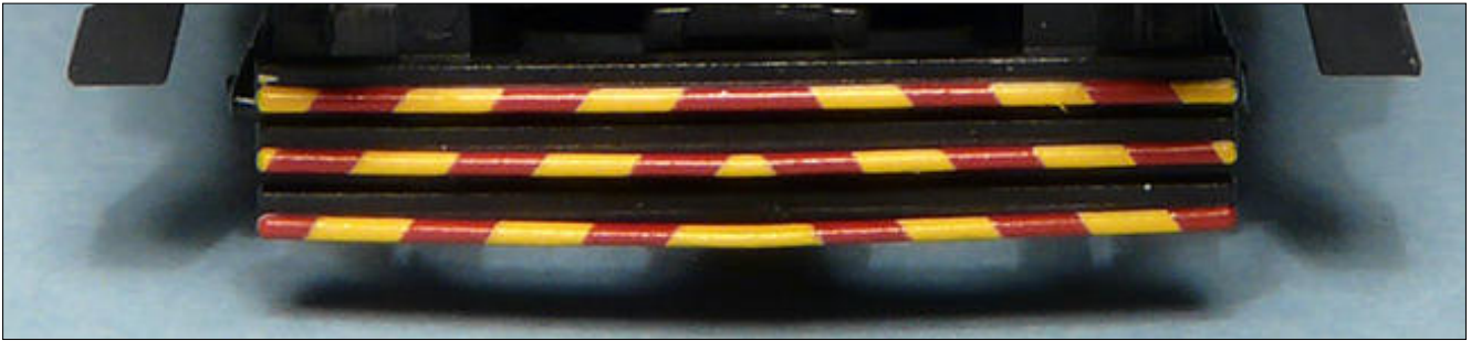
Obr.9: Detail pluhu. Za ním je vidět šachta spřáhla, pro níž je nutno udělat ve dvou vrchních lištách výřez.
