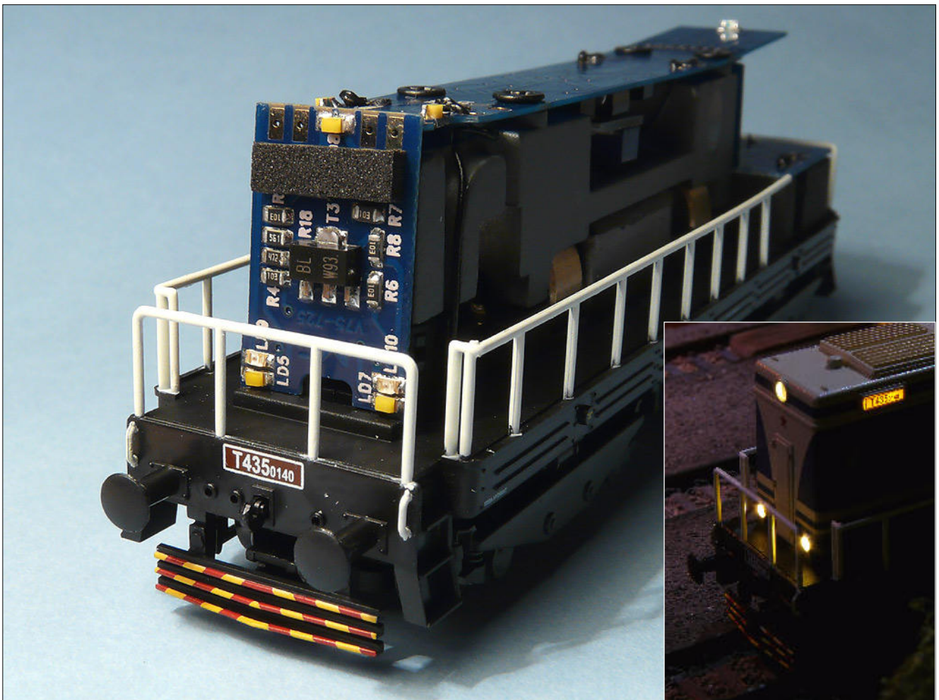
Obr.5: Pohled na přední desku plošného spoje. Jsou vidět všechny SMD ledky včetně těch v tabulce s číslem.
