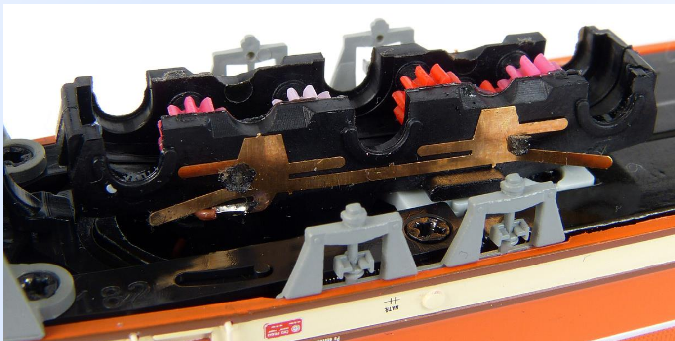
Obr. 13: Sběrače proudu. Přihnutím lze získat sběr i ze středního dvojkolí.
