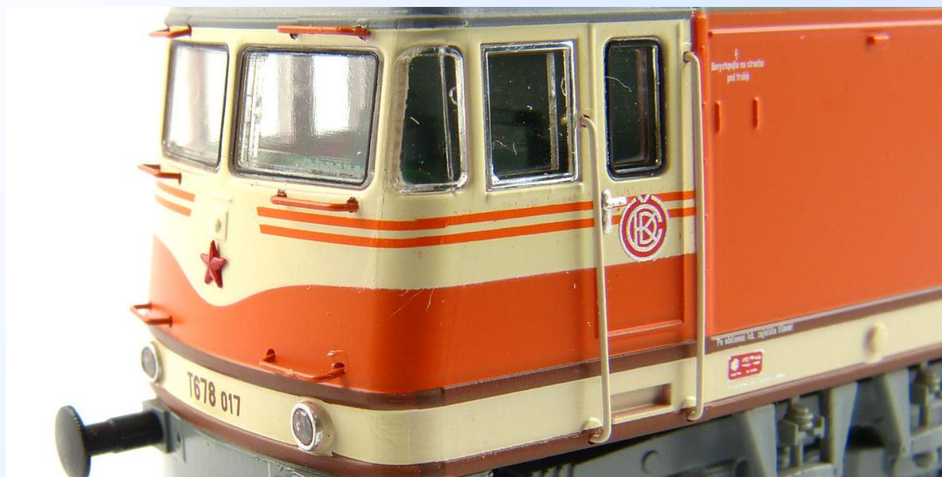
Obr. 7: Barevné pavučinky a nepřesně navazující proužky, různý sklon čelních madel.
