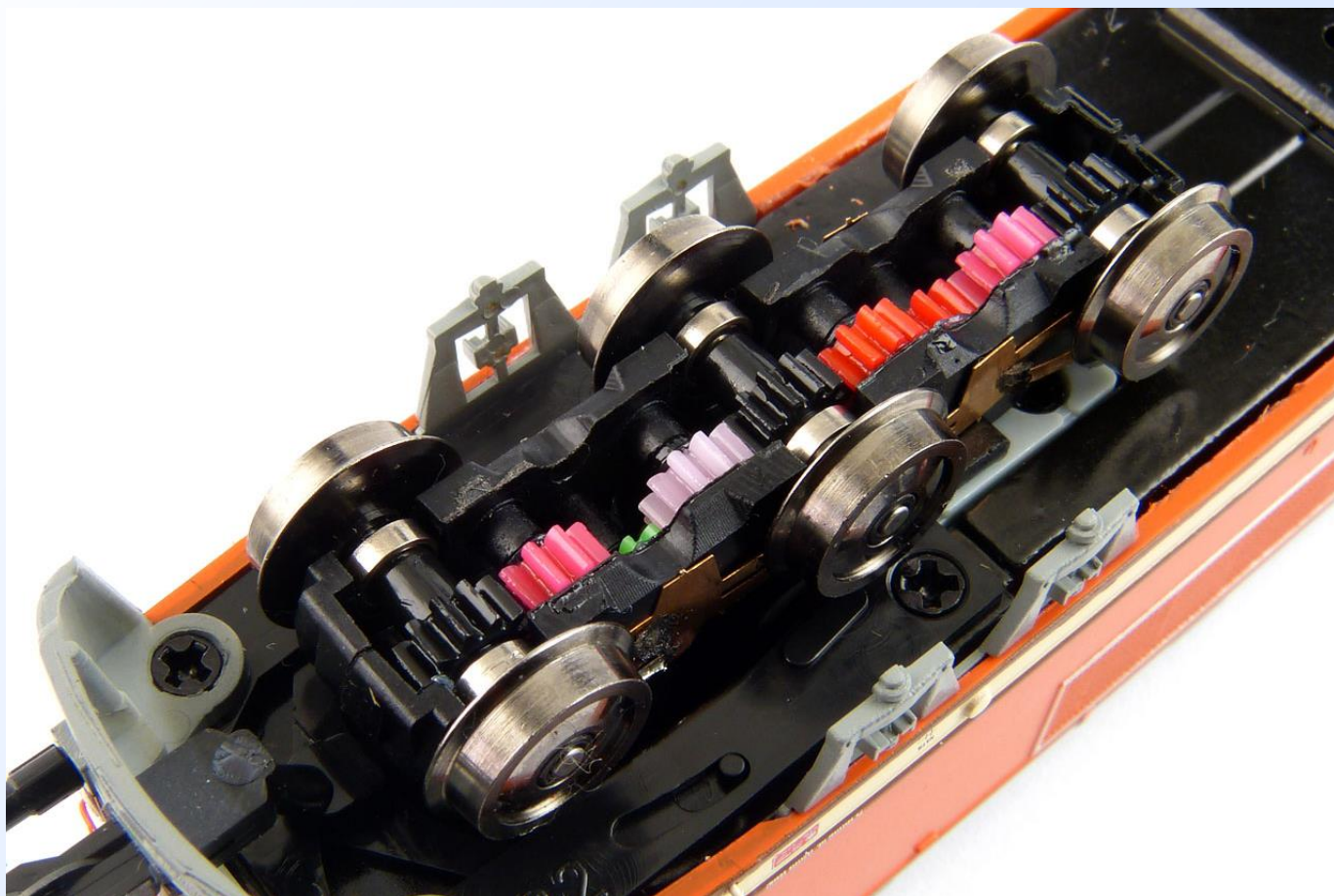
Obr. 12: Detail převodů a ložisek v podvozku.
