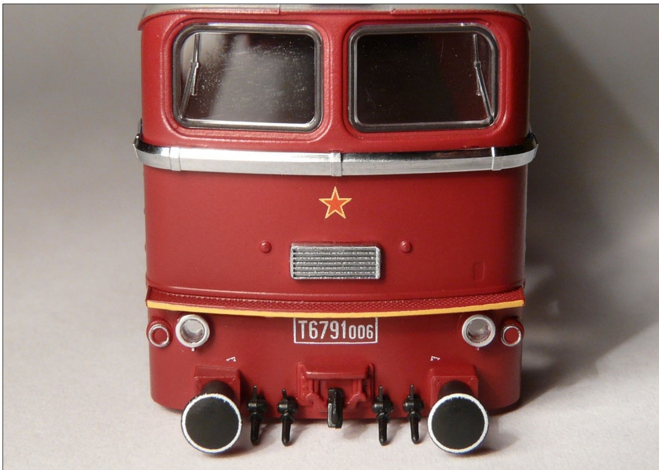
Obr. 1: Detail čela lokomotivy – hadice, hák, nárazníky, světla, okna.
