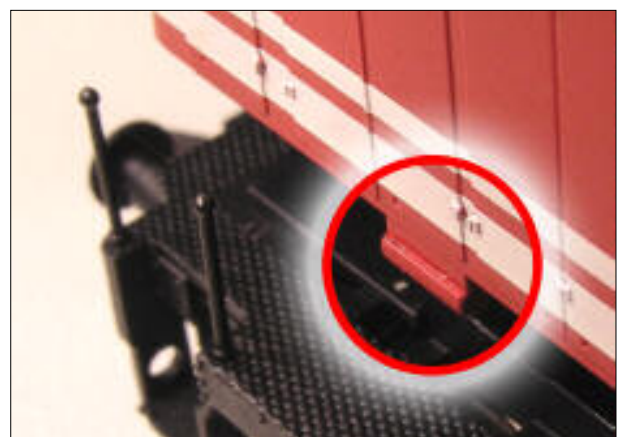
Obr.18 – Zámky na spodním dílu skříně
