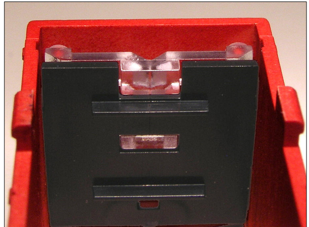
Obr. 22 – Světlovody na čele skříně.
