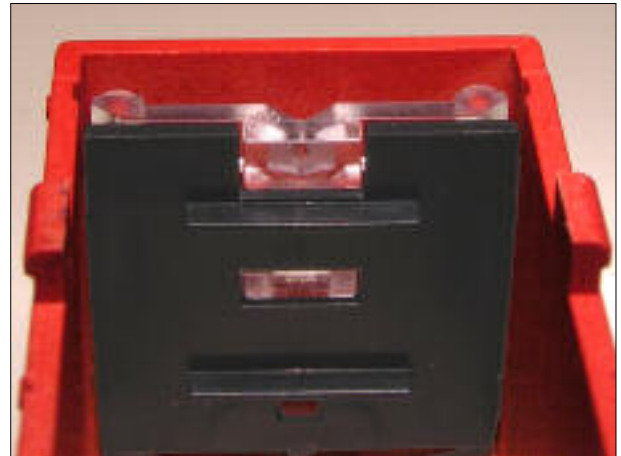
Obr.22 – Světlovody na čele skříně
