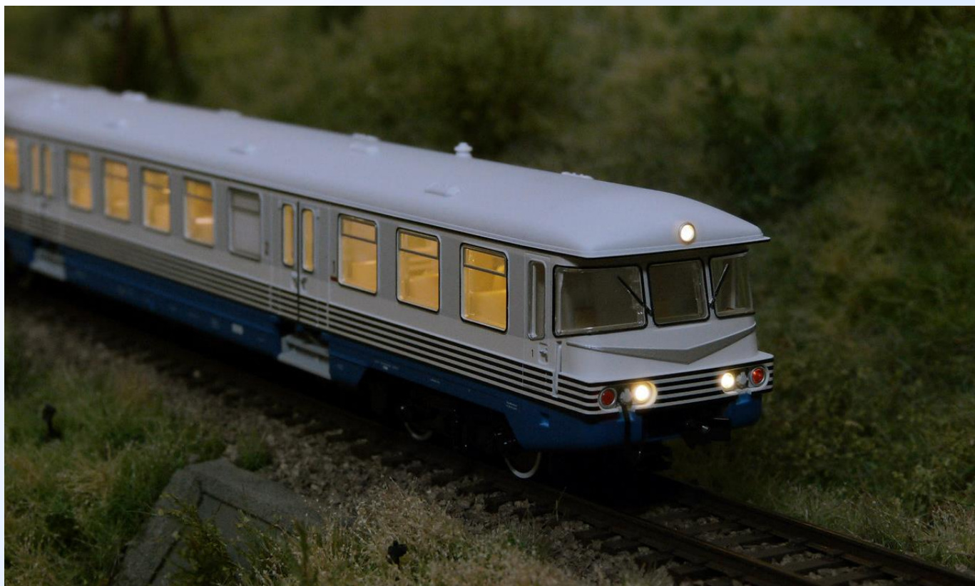
Obr. 17: Osvětlení modelu. Zde je vidět slabé prosvítání bílého světla v koncových reflektorech.
