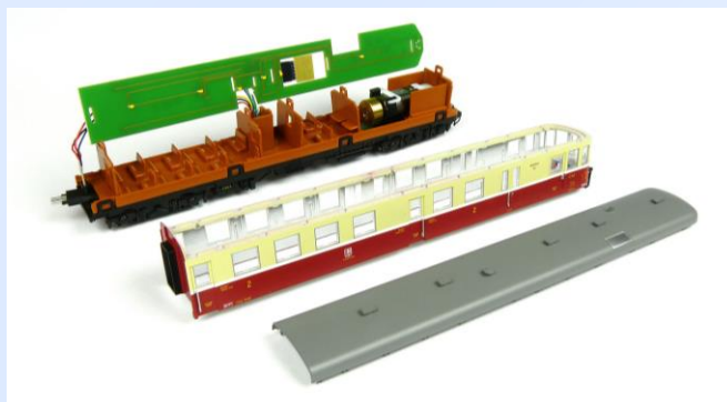
Obr. 5 a 6: Hnaný podvozek s bandážovanými koly a běžný podvozek s oboustranně izolovanými nápravami.
