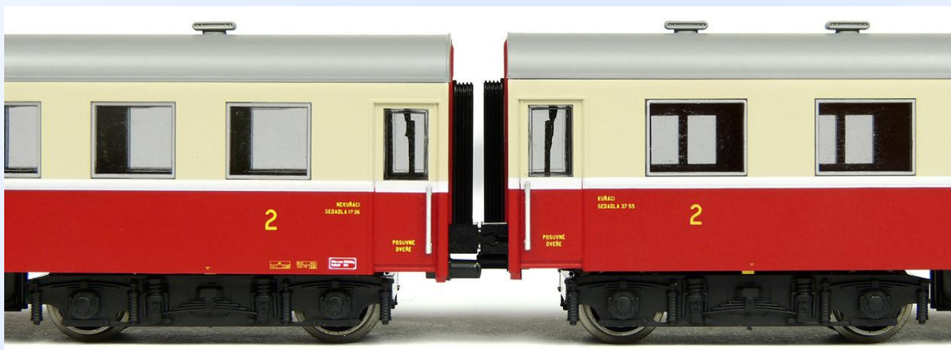
Obr. 3: Spoj dílů v tahu, vzdálenost činí asi 1 mm. V tlaku jsou měchy téměř na sobě.
