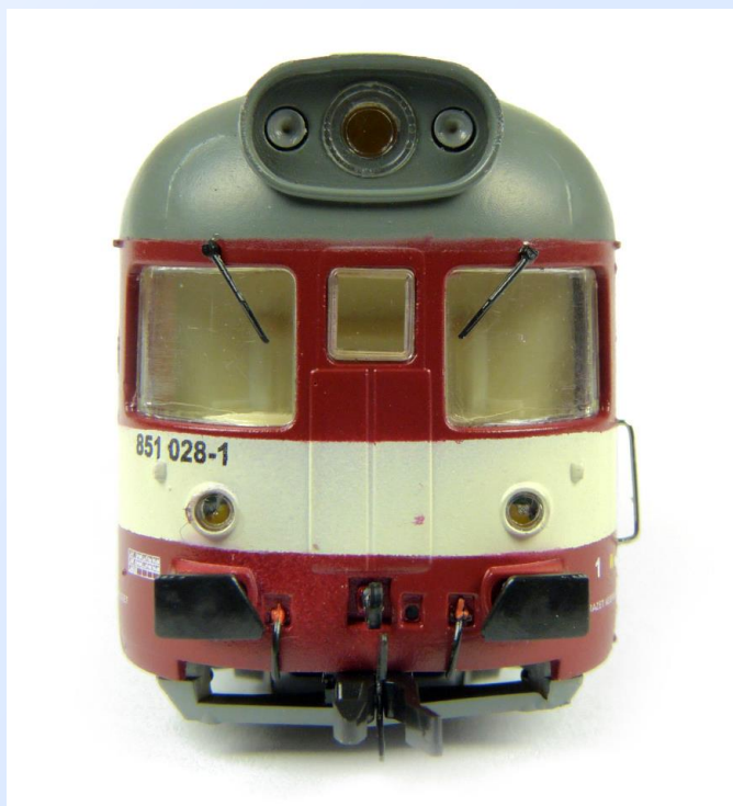
Obr. 3 a 4: Čelní pohledy. Jsou patrné např. nedostatky v nástřiku na červené ploše mezi nárazníky a špatný přechod střecha/čelo.
