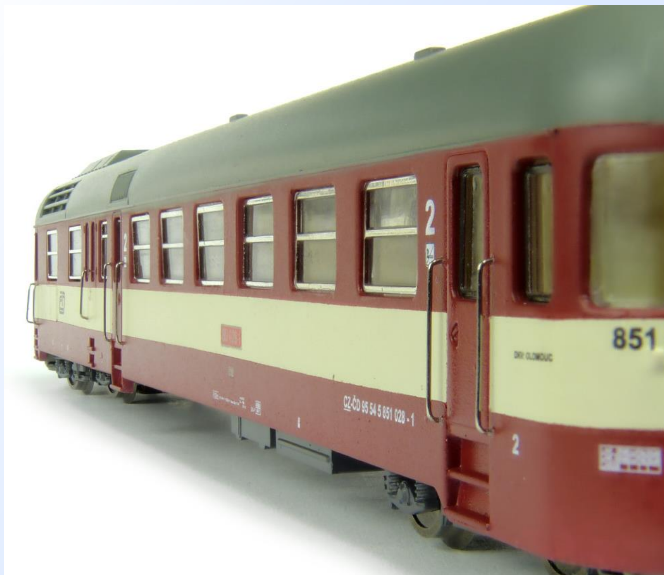
Obr. 14: Nerovnost krémového pruhu, zapadlá okna a nerovně nainstalovaná madla.
