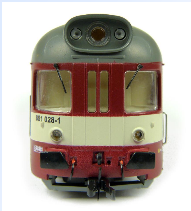
Obr. 3 a 4: Čelní pohledy. Jsou patrné např. nedostatky v nástřiku na červené ploše mezi nárazníky a špatný přechod střecha/čelo.
