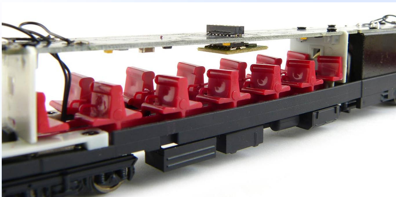
Obr. 13: Interiér a hlavní DPS s rozhraním PluX16 a vnitřním osvětlením.
