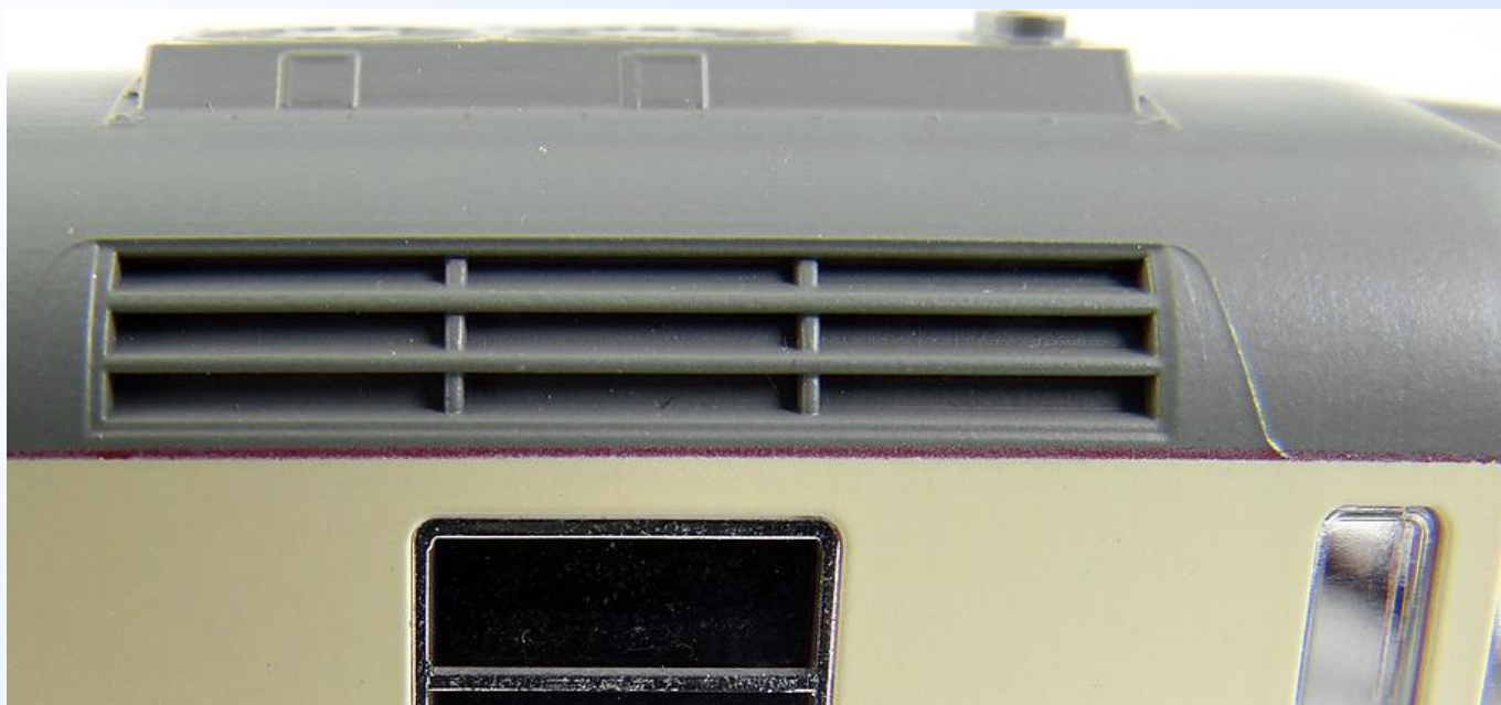
Obr. 9: Dělicí roviny formy, nepovedené přechody barev.
