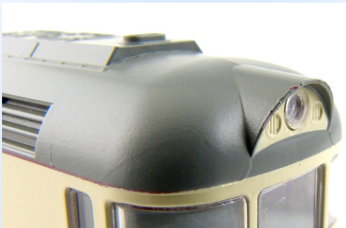
Obr. 8: Oloupaná barva u horního reflektoru, dělicí roviny formy, nepovedené přechody barev.
