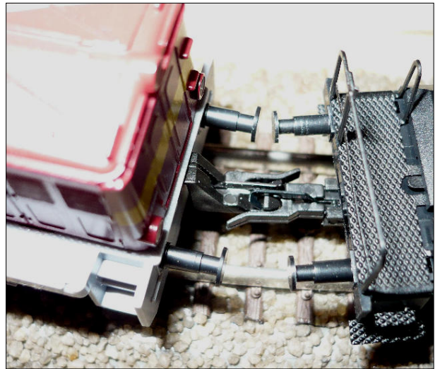
Obr.20 – Spřažení s upraveným spřáhlem v otočném uchycení
