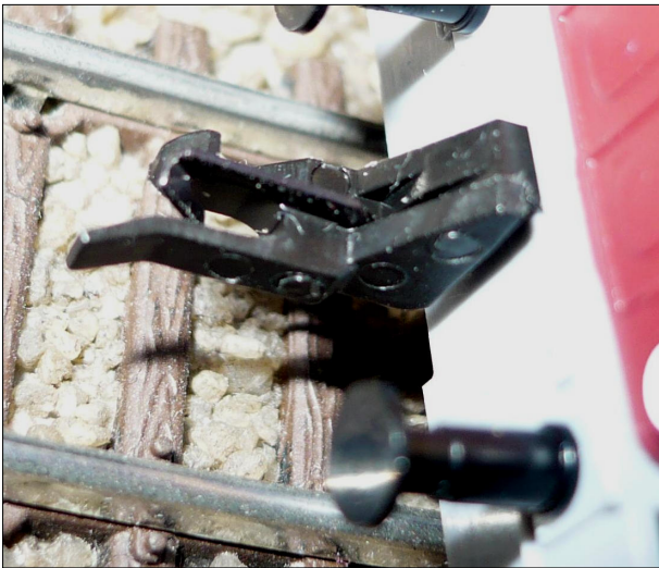
Obr.19 – Otočně uchycené upravené spřáhlo v původním uchycení
