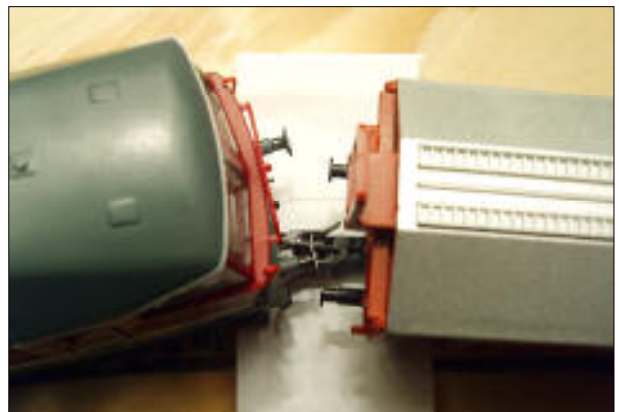
Obr.14 – Spojení Roco (dlouhé vozidlo) x Tillig v oblouku
