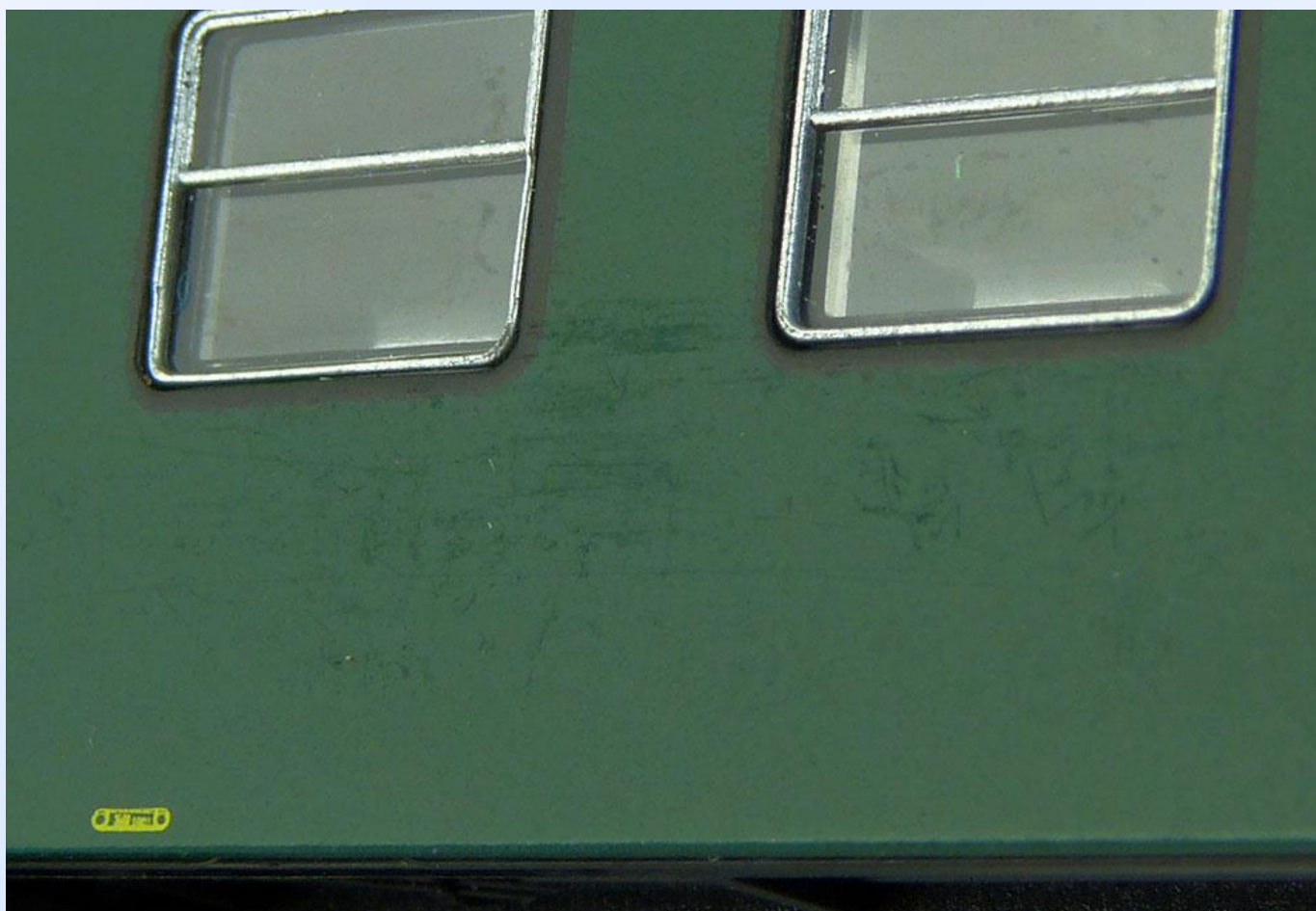
Obr. 12: Oděry na skříni, způsobené absencí výstelky v balení.
