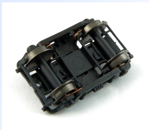
Obr. 7: Kinematika, otočné schůdky a otvor pro uchycení podvozku. Ten je nutné zvětšit pro lehké otáčení podvozku.
