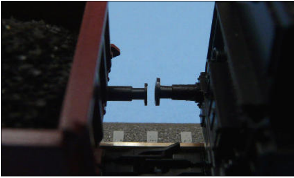
Obr.14 a 15 – Vzdálenost mezi nárazníky při spojení s vozem s kinematikou Tillig, vlevo v tahu, vpravo při sunutí
