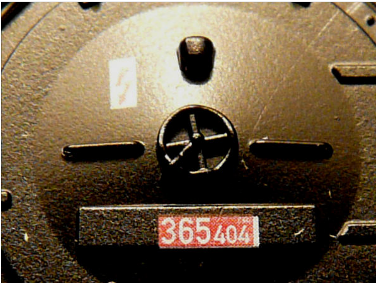
Obr.8 – Tabulka s číslem na čele lokomotivy, malá a odsazená mimo osu
