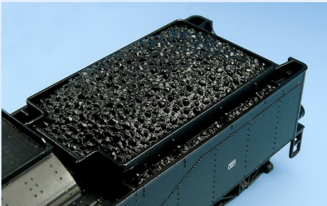
Obr. 4: Uhlí s přesypnými uhlíky mimo zásobník. Uhlí i tělo tendru jsou z kovu.
