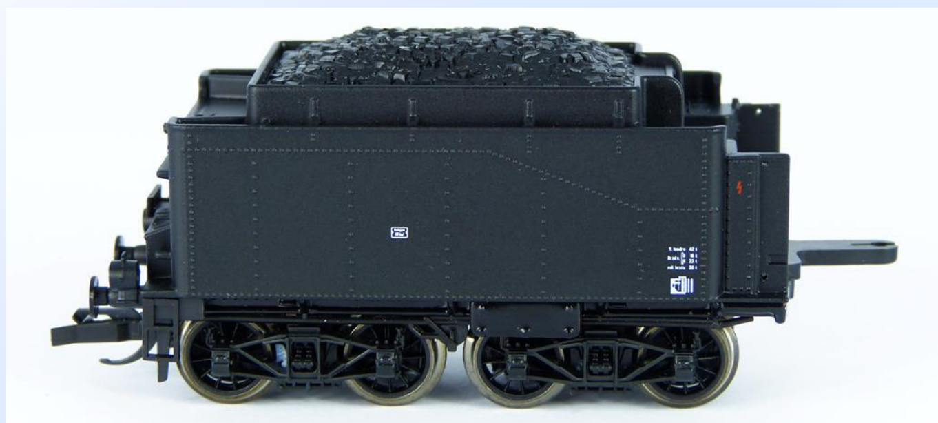
Obr. 7: Tendr s plastovým uhlím a kovovou skříní.
