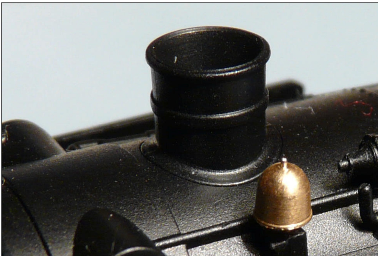
Obr.2: Mosazný zvon by na českém provedení být neměl. S trochou opatrnosti je možné jej z modelu odstranit.
