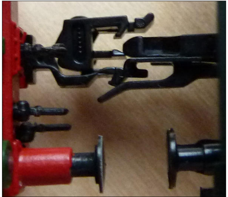
Obr.10 – Nové spřáhlo Roco vs. spřáhlo Tillig – plně nekompatibilní.
