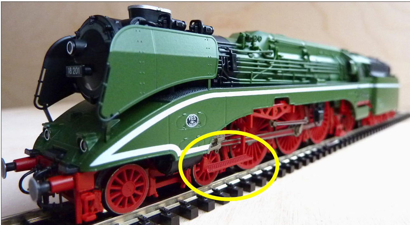
Obr.3 – Podlouhlá stupačka u válců byla původně černá. Lak se ale loupal.
