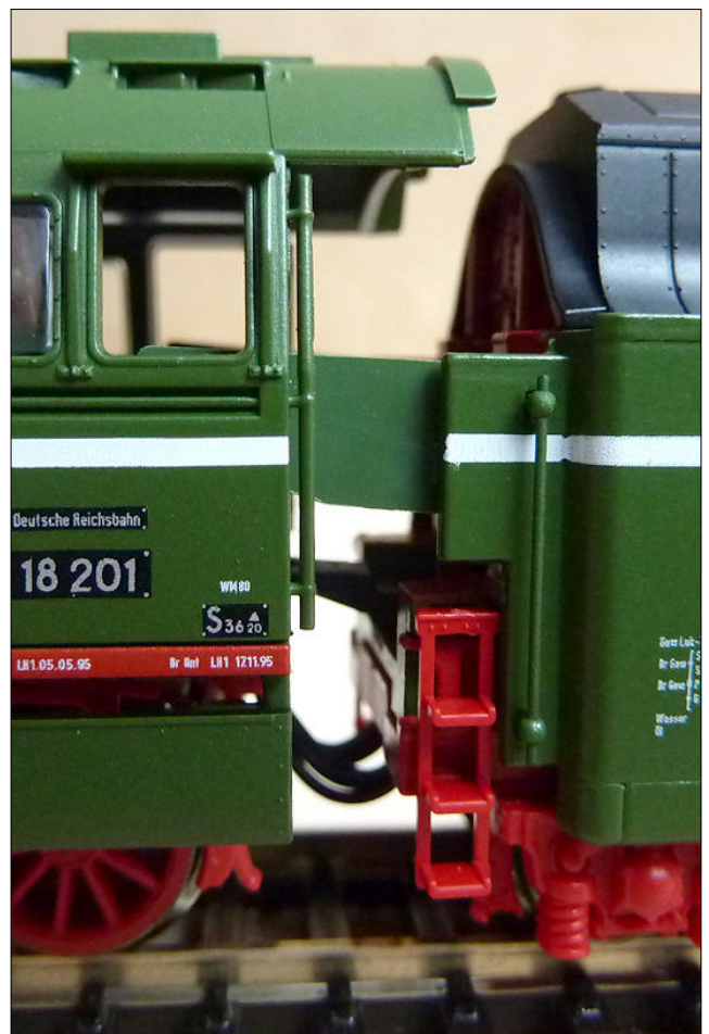
Obr.15 – Pevné spojení lokomotivy a tendru.
