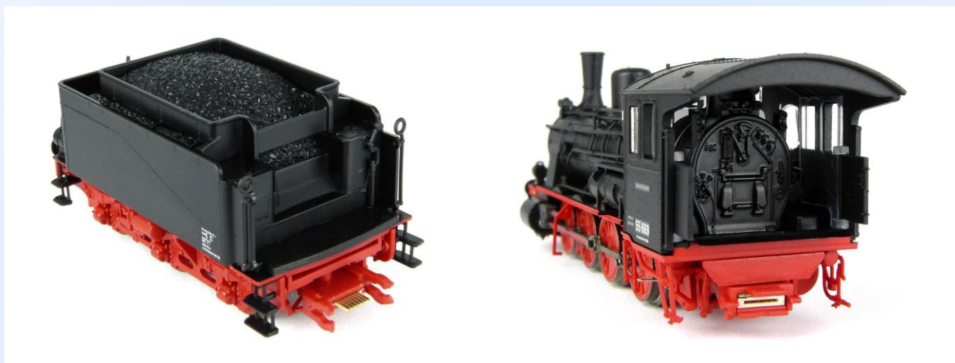
Obr. 9 a 10: Spojení lokomotivy a tendru. Jsou patrné konektory i zámečky.
