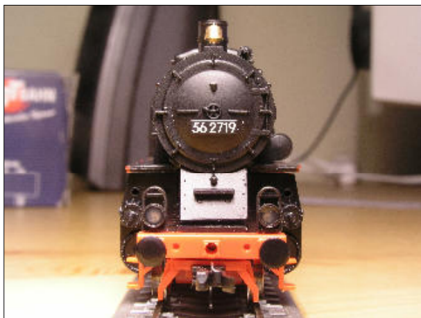
Obr.16 – Čelní světla lokomotivy - LEDky jsou uvnitř
