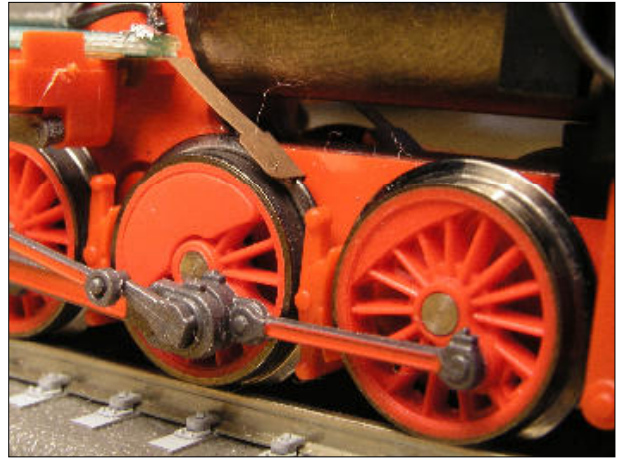
Obr.20 – Detail sběrače proudu na obandážovaném kole
