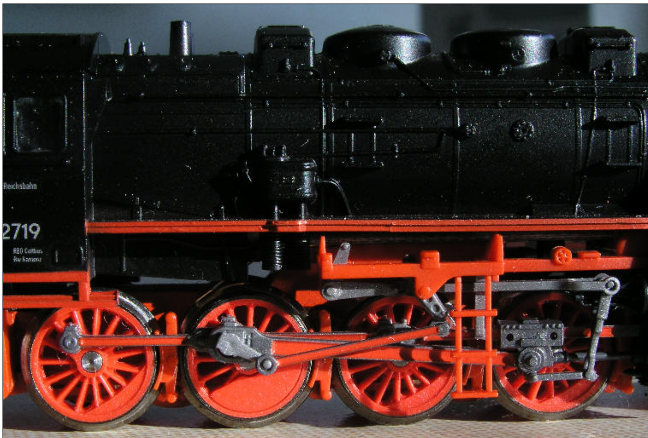
Obr.10 – Přepracované rozvody jsou rovněž z plastu
