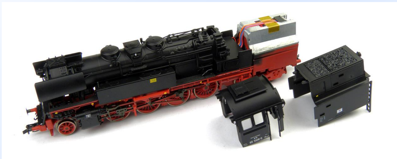
Obr. 9: Model se sejmutým krytem tendru a budkou strojvedoucího.
