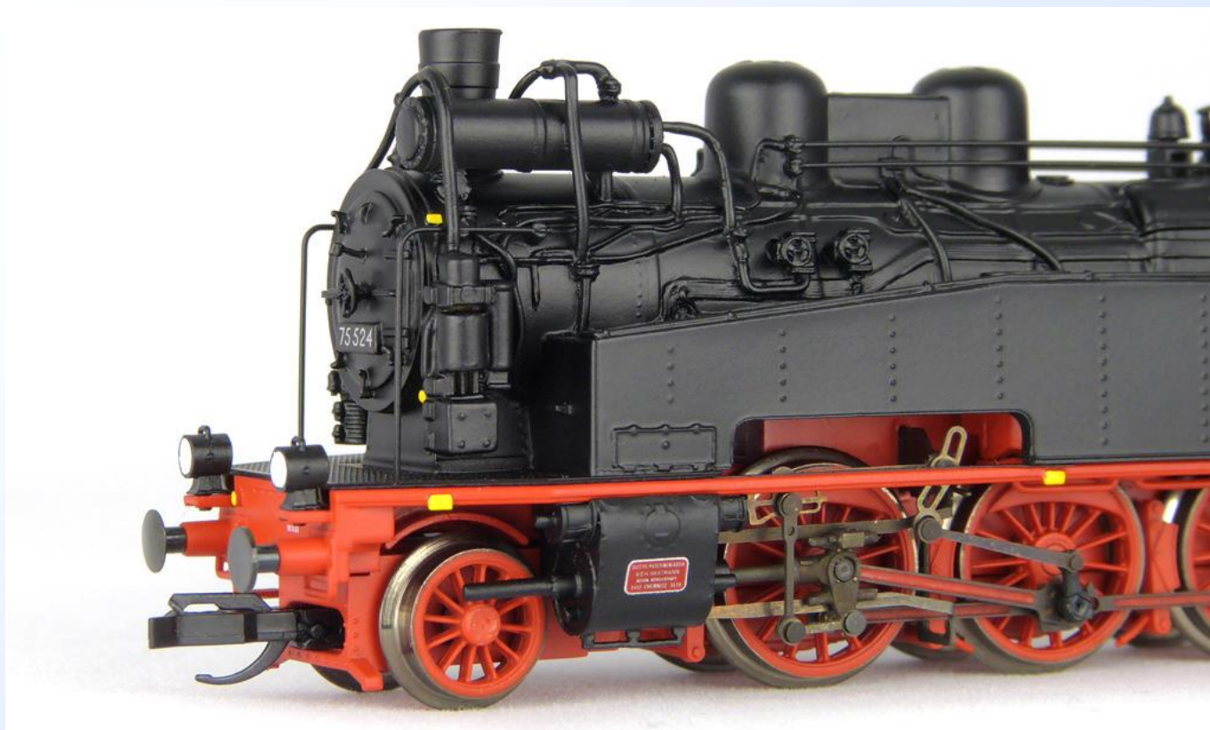
Obr. 6: Pohled na přední partii modelu, válce a rozvody.
