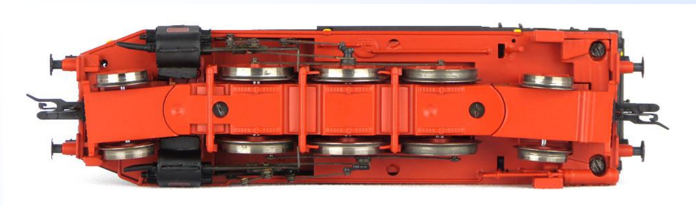
Obr. 10: Spodek modelu. Vpravo za zadním běhounem jsou patrné dva šroubky, které drží spolu s třetím v komínu kryt na pojezdu.
