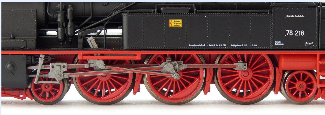
Obr. 8: Detail plastových rozvodů.
