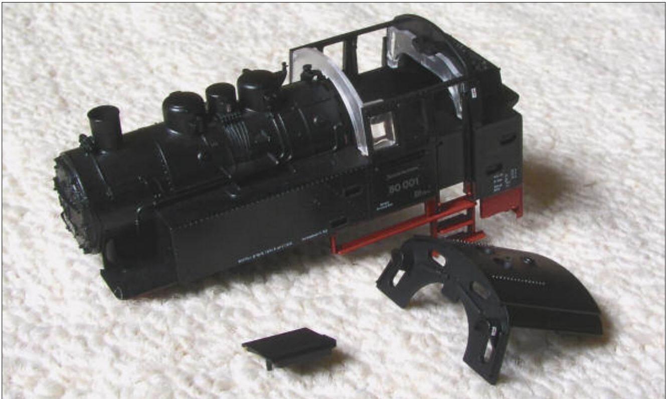
Obr.2 – Budka strojvedoucího se skládá z několika dílů
