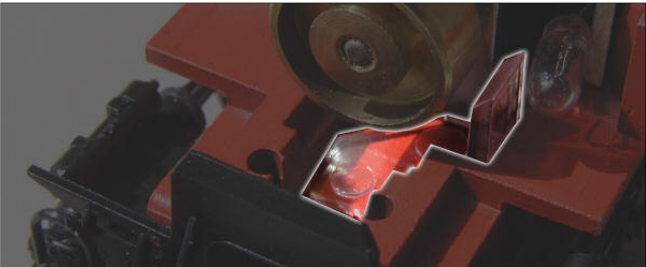
Obr.14 – Světlovod k předním světlům
