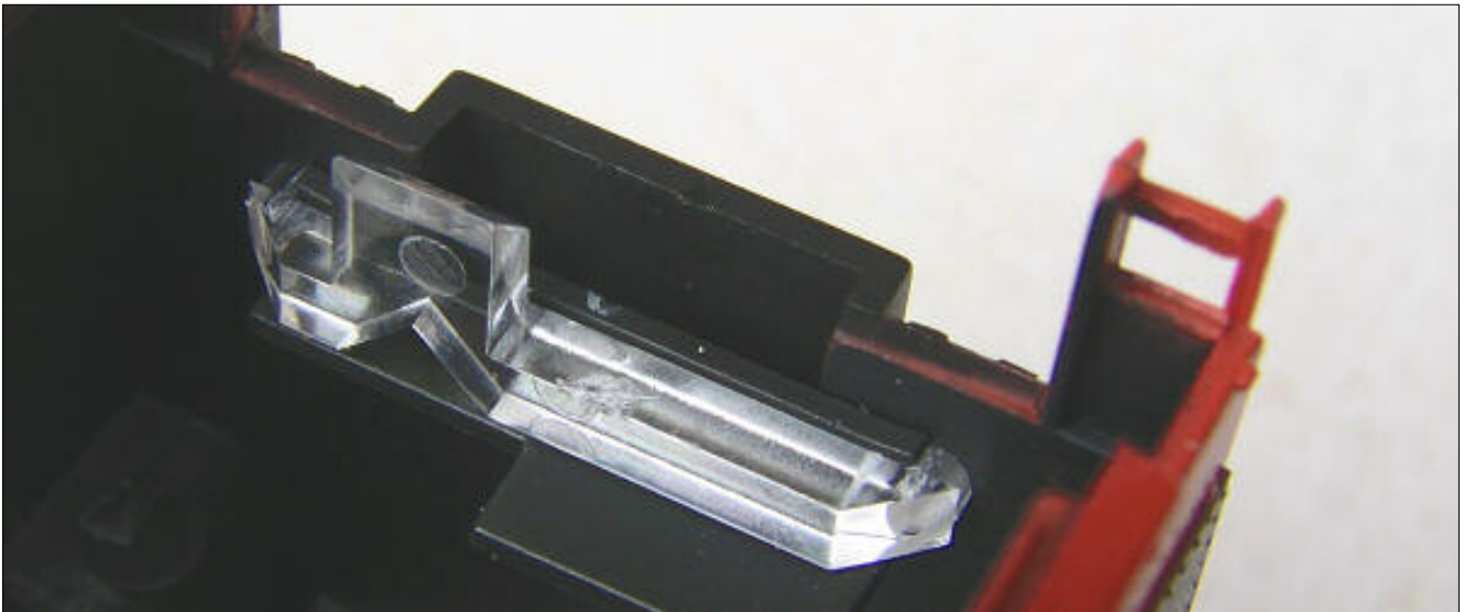
Obr.18 – Světlovod k zadním světlům
