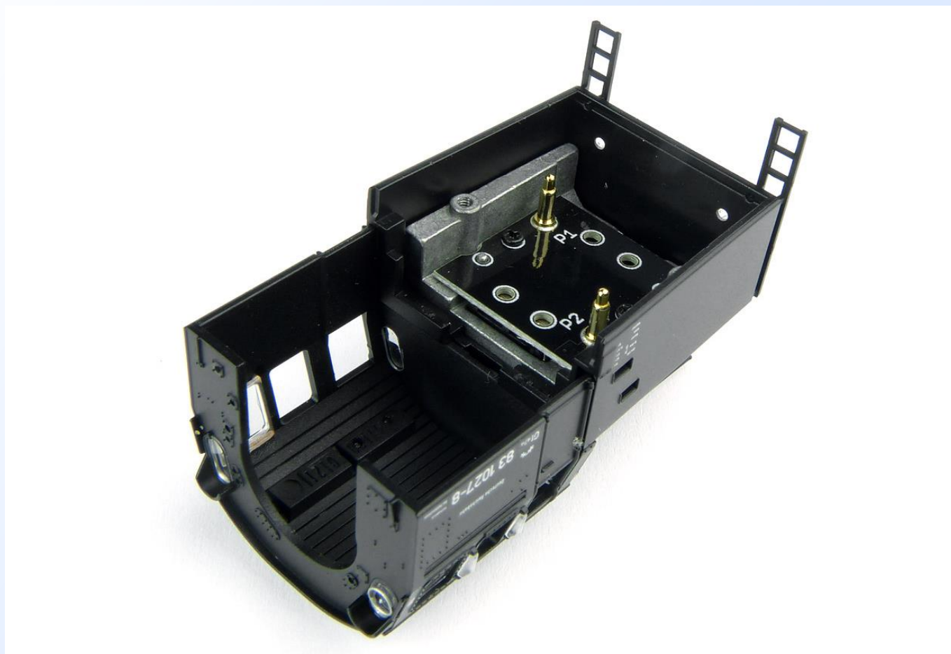
Obr. 12: Pohled do vnitřku budky a tendru. Dutinkové pružné kontakty spojují reproduktor s deskou.
