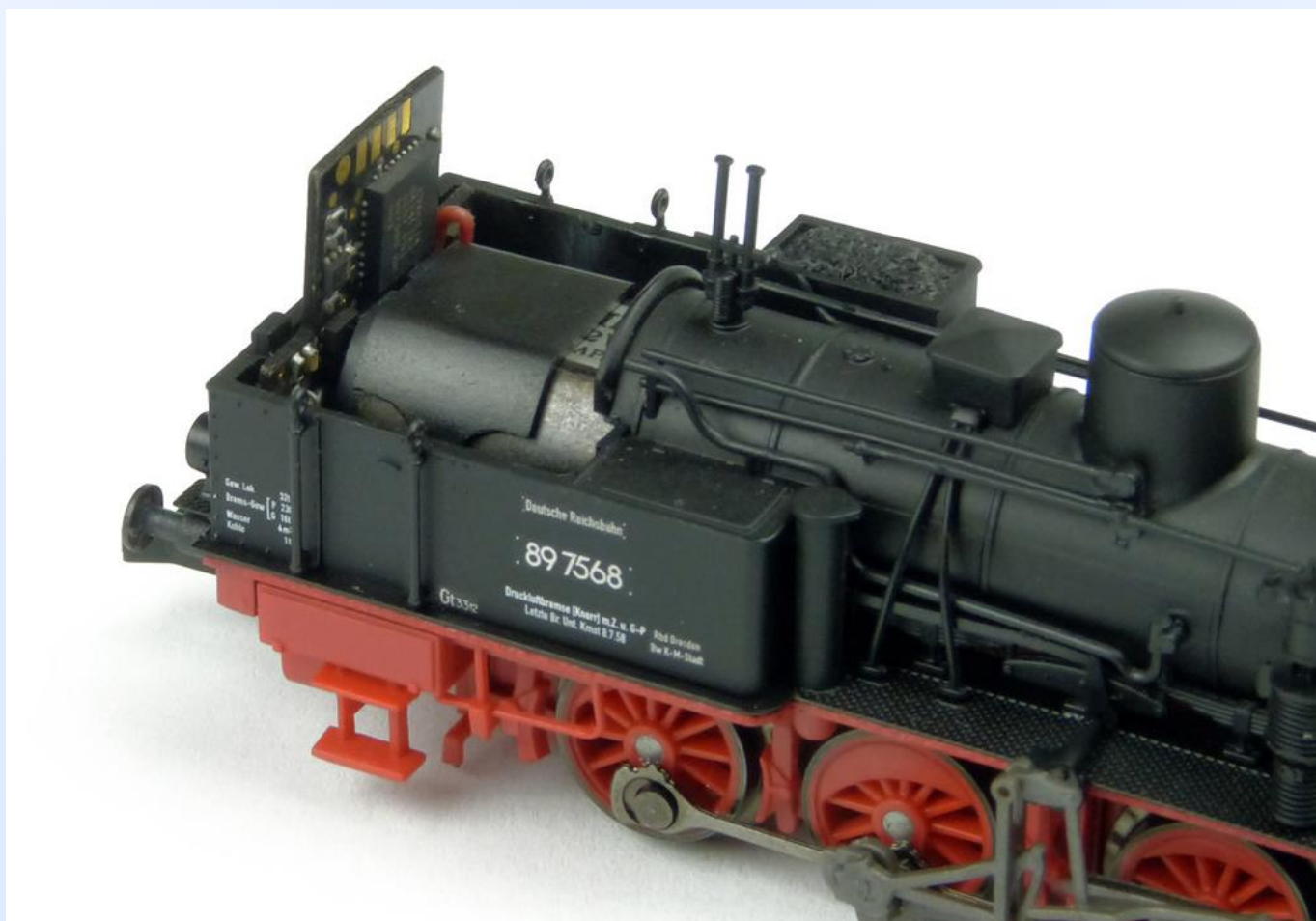
Obr. 9: Motor a deska s dekodérem.
