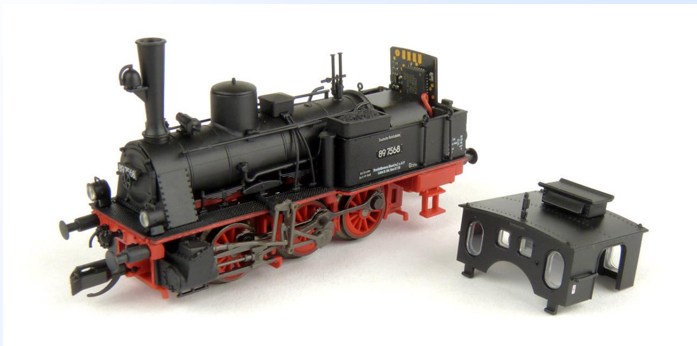
Obr. 8: Sejmutý vrchní plastový díl budky strojvedoucího.
