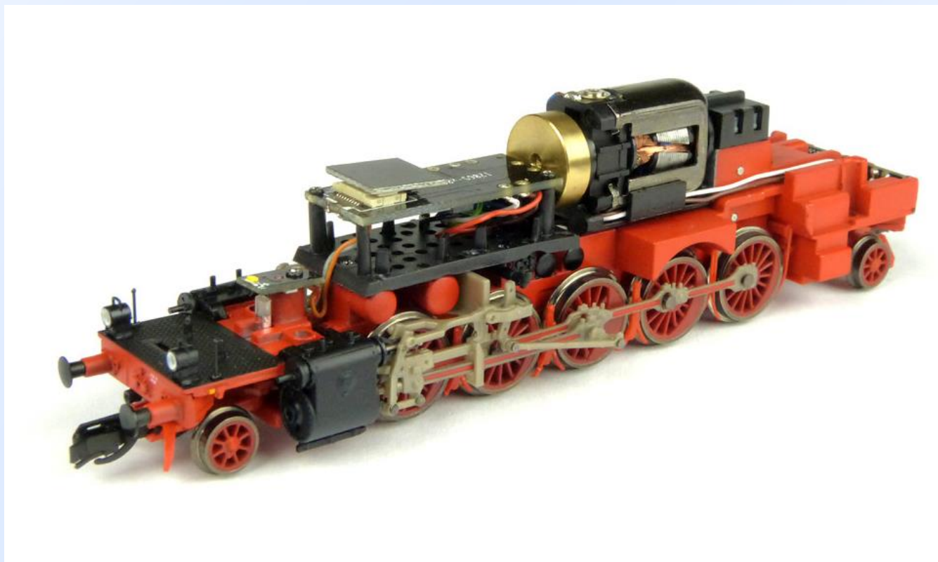
Obr. 11: Odkrytý pojezd. Dobře je patrný prostor pro reproduktor pod plošným spojem.
