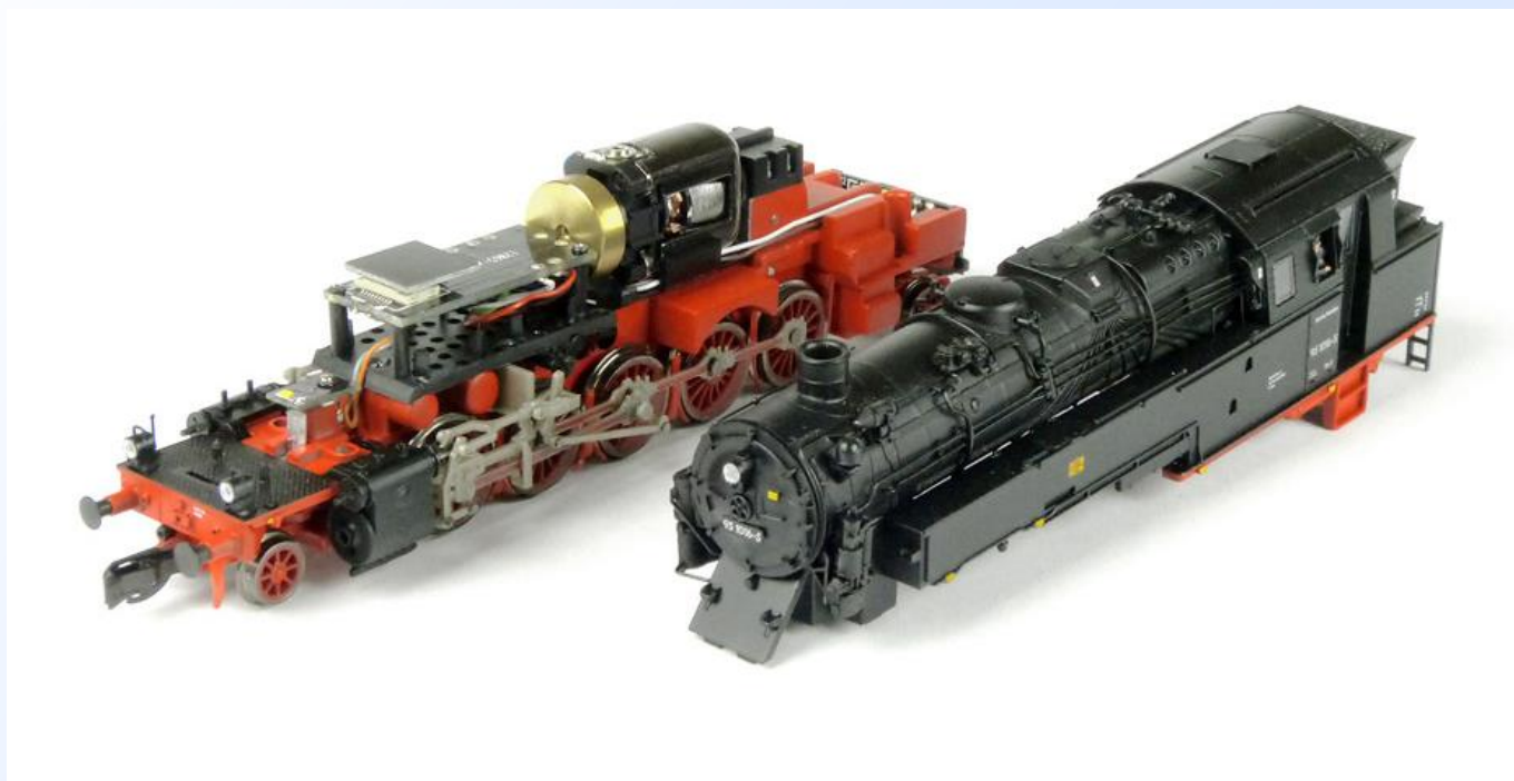
Obr. 10: Rozebraný model. Vrchní díl drží na rámu čtyři šroubky.
