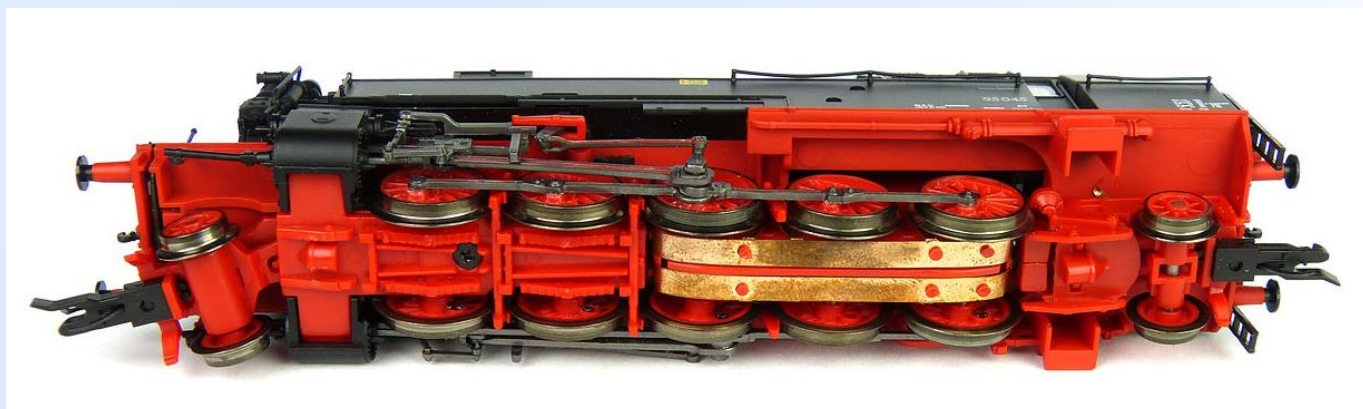
Obr. 3: Pojezd modelu – zde je vidět, jak přední běhoun bez pružinky volně visí.
