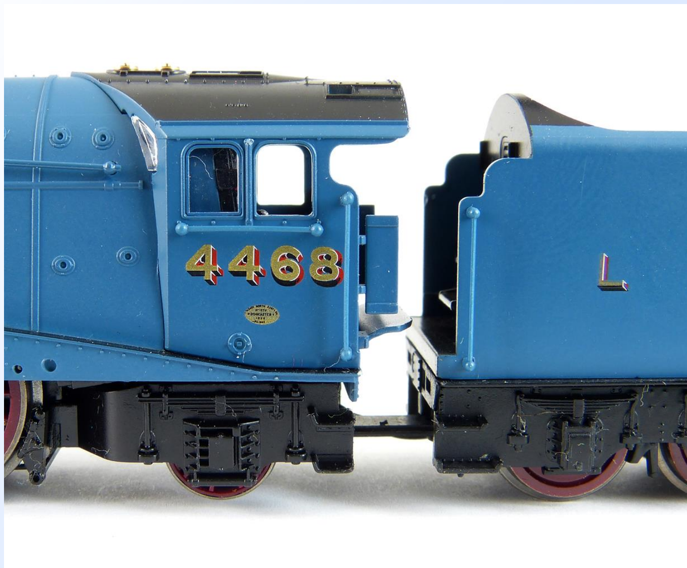
Obr. 8: Lokomotiva s tendrem jsou pevně spojeny bez kinematiky.
