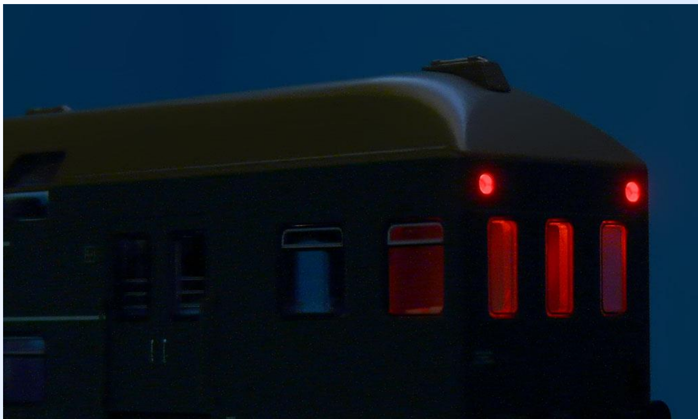
Obr. 13: Prosvítající koncové osvětlení. Viditelné je to pouze ve tmě.
