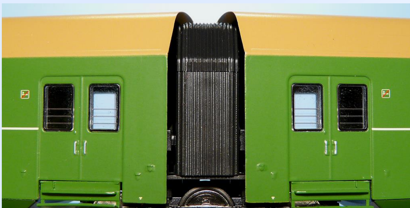
Obr. 9: Mezery mezi měchem a skříněmi v oblouku o poloměru 310 mm.
