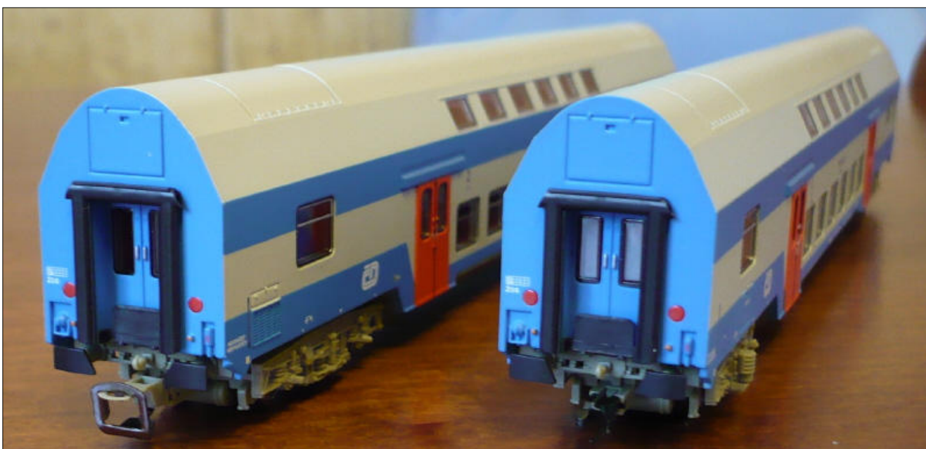
Obr.15 – Čela vozů se starým a novým spřáhlem
