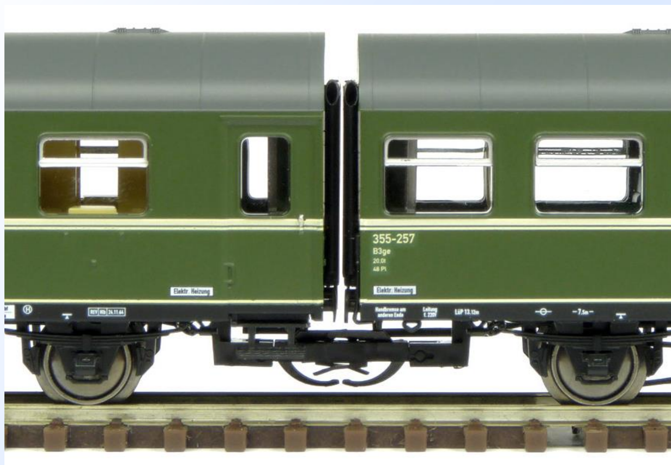
Obr. 13: Mezera mezi dvěma spojenými vozy je cca 0,5 mm.
