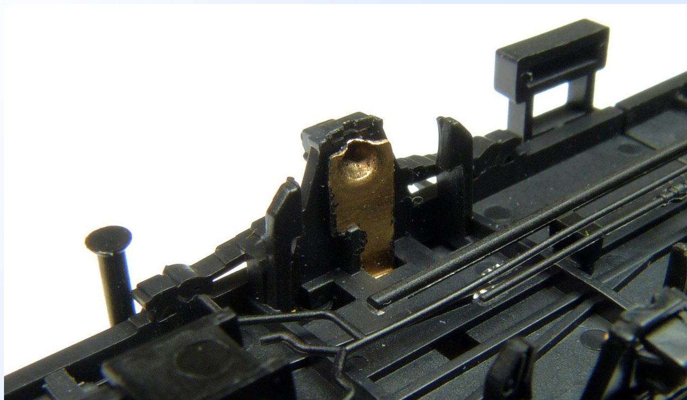
Obr. 11: Detail uložení dvojkolí ve fosforbronzových ložiskách.
