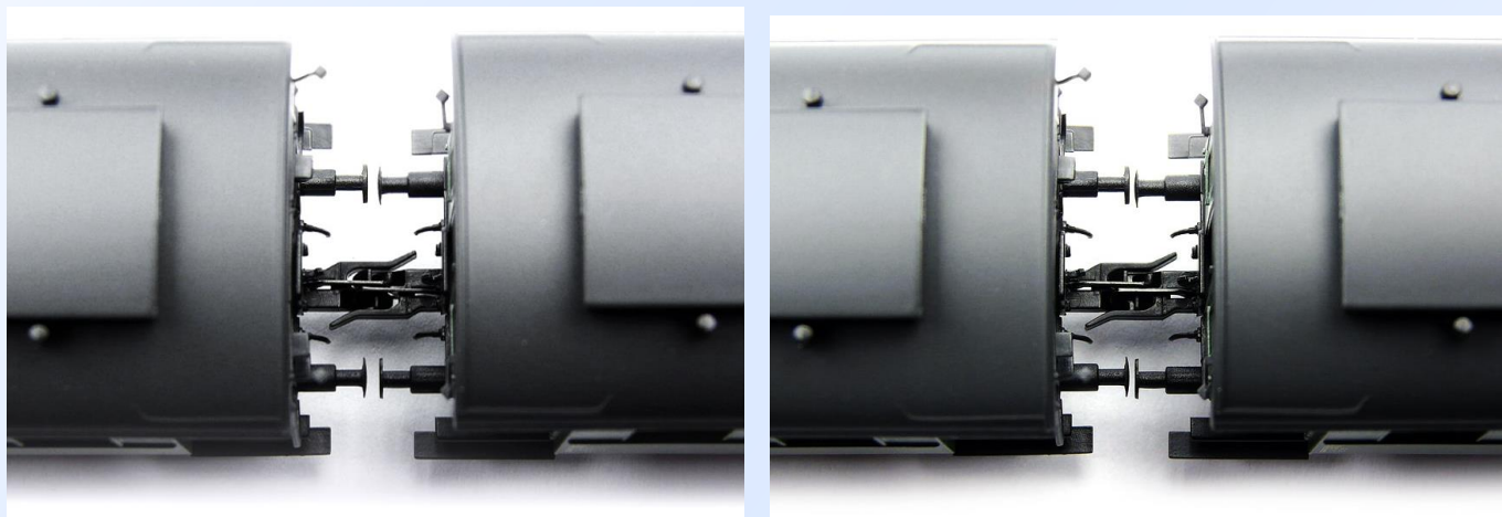
Obr. 18 a 19. Vzdálenost mezi nárazníky v tahu a v tlaku.
