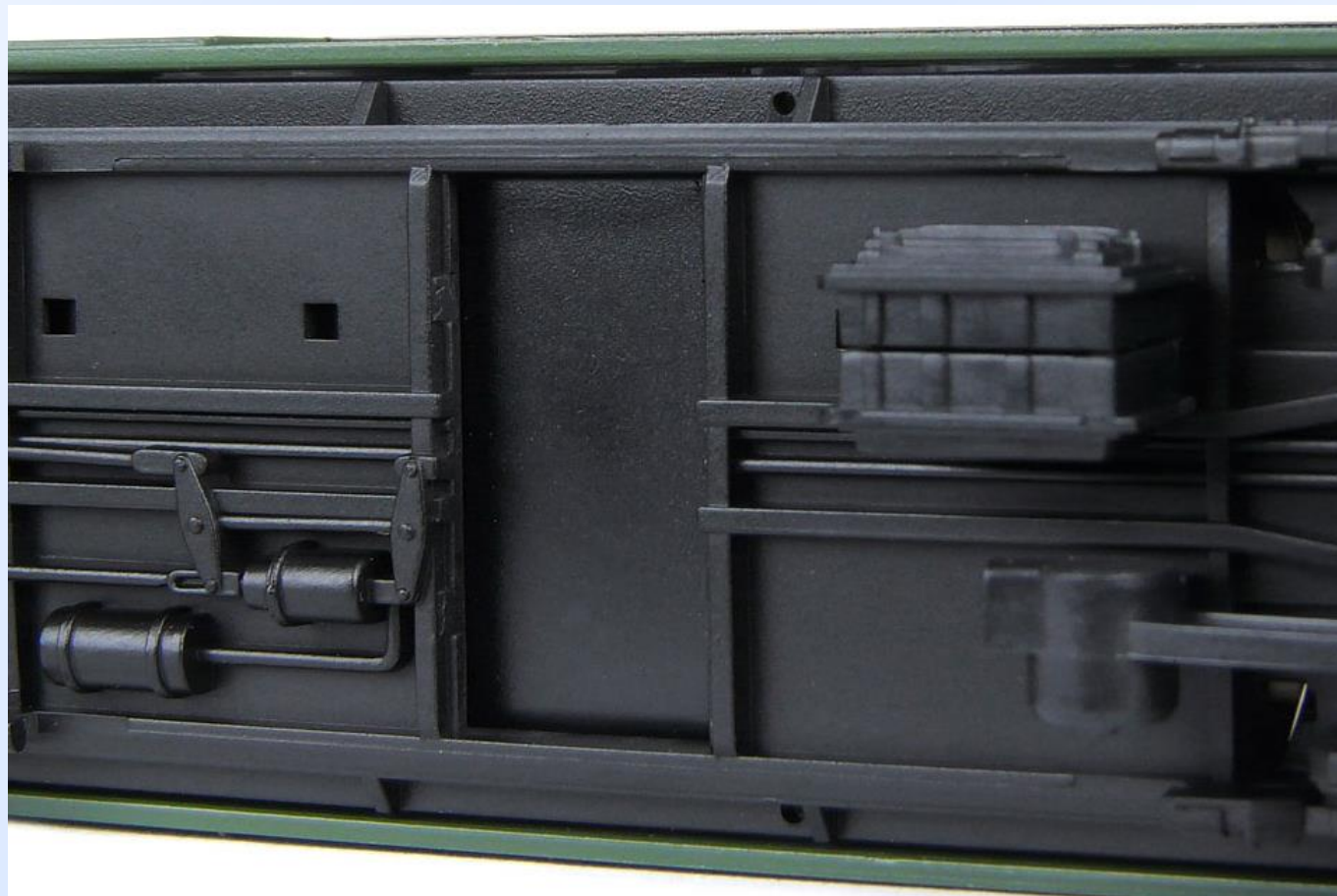
Obr. 10: Spodek vozu a vybrání s drážkami pro střední nápravu.
