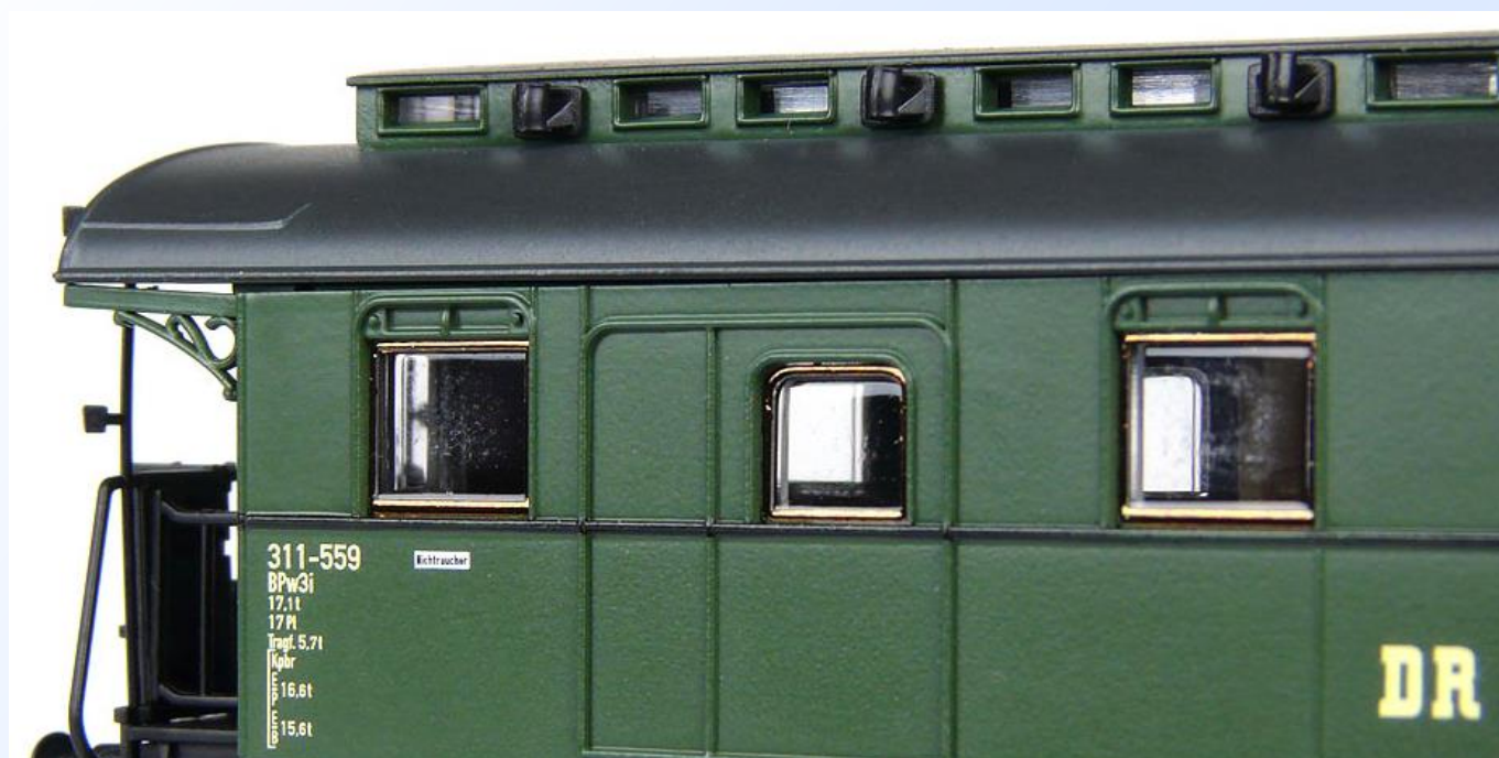
Obr. 9: Zde je dobře vidět, jak střecha nesedí úplně přesně.
