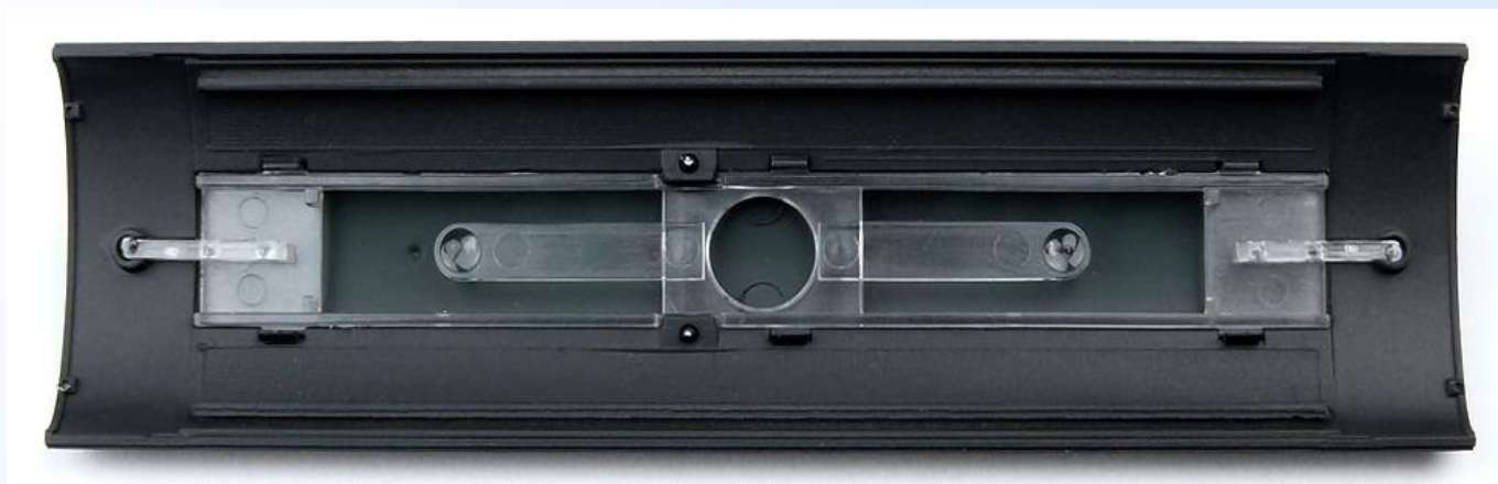
Obr. 17. Spodní strana střechy. Patrné jsou světlovedy ke svítlárnám na plošince nebo v představku.
