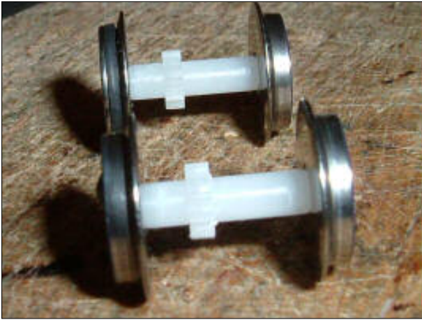
Obr.9 - Dvojkolí s plastovými hřídelemi
