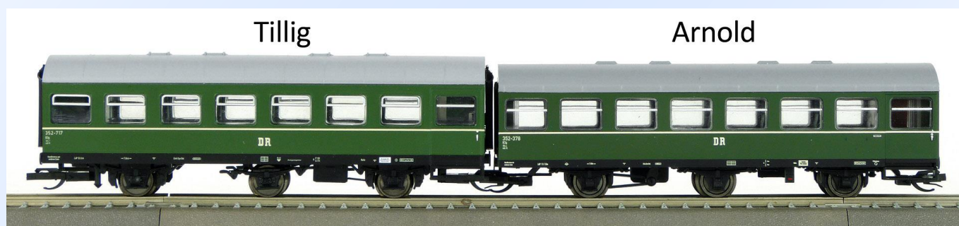
Obr. 6: Vozy spojené ve vlaku, pohled více z čela. Rozdíl výšek zde vynikne ještě více.
